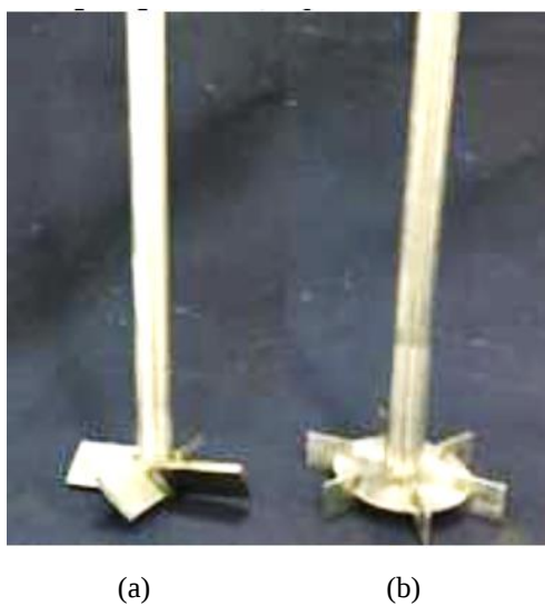
Figura 9 – (a) Impulsor axial com 4 pás, (b) Impulsor radial com 6 pás
