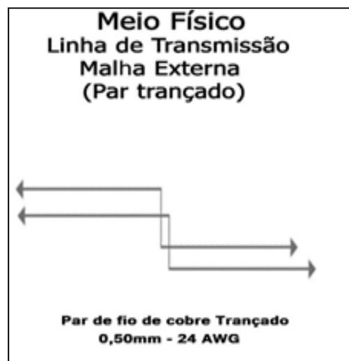
Figura 9. Linha de Transmissão (LT) de uma malha externa (par de fio de cobre).
