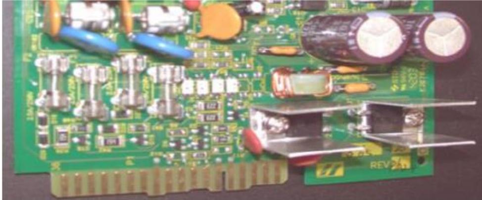
**Figura 25. Proteções do módulo.**
