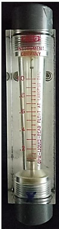
Figura 7 – Rotâmetro que foi instalado na alimentação de água do evaporador submerso
