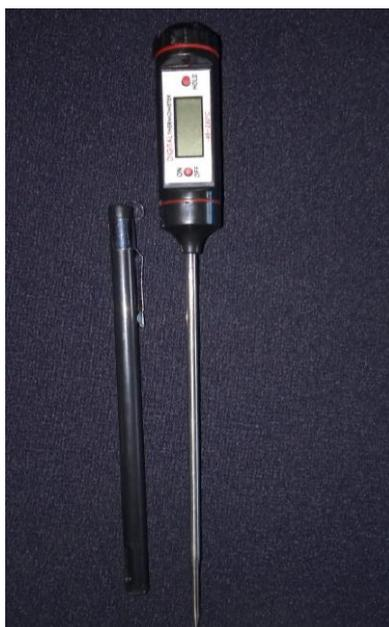
Figura 11 – Termômetro digital do tipo espeto calibrado
