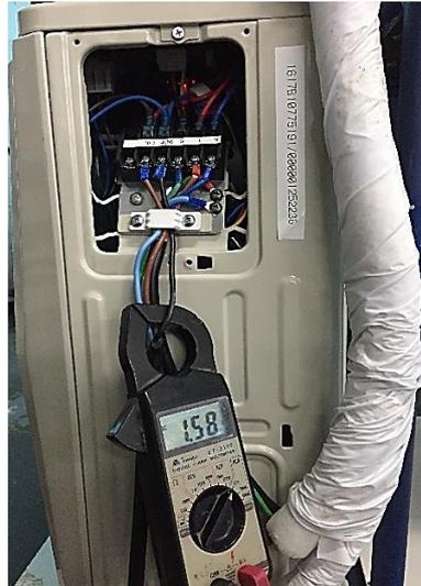
**Figura 9 – Alicate amperímetro para aferição da corrente do sistema**
