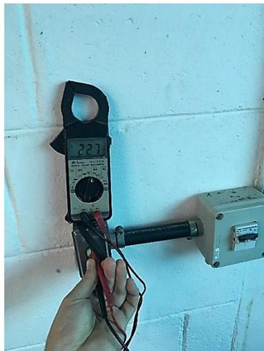
**Figura 10 – Alicate amperímetro para aferição da tensão de entrada no equipamento**
