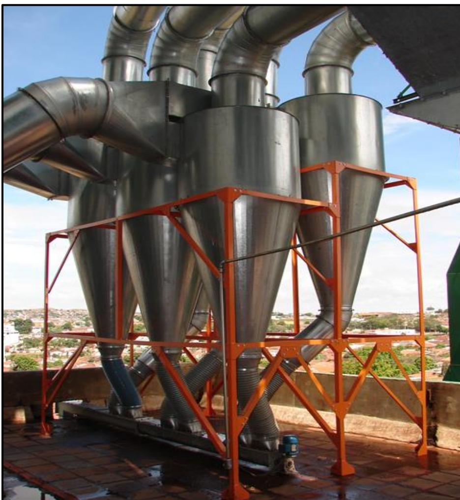
Figura 3.9 - Modelo de Ciclone Industrial Metálico, Separador de Sólido/Fluido.
