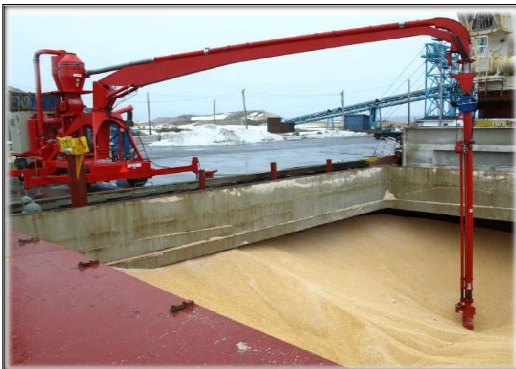
Figura 3.13 - Sistema Sugador de transporte pneumático de sólidos para descarga de navios em fase densa, operando com pressão negativa. Fonte: Internet, Google Imagem em 30/06/2018.
