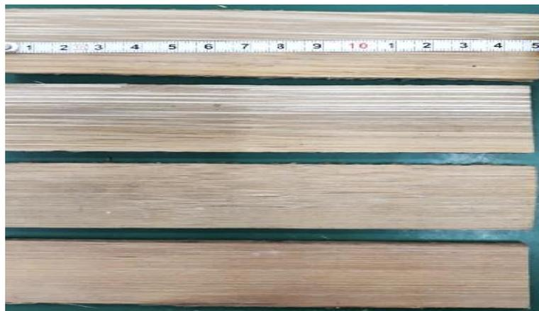
Figura 19 - Preparação da ripa de bambu Mosô, para os corpos de prova.
