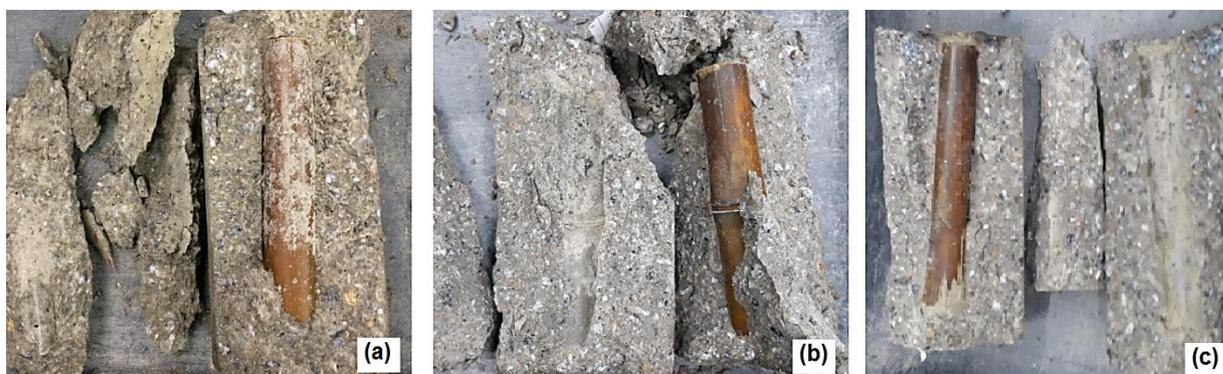
**Figura 48 - Corpos de prova cilíndricos com nó, ensaiados para análise interna: (a) Aderência da estrutura cilíndrica com o concreto. (b) Demonstração da estrutura cilíndrica com nó. (c) Aspecto geral do Concreto com a estrutura de vara após o rompimento.**
