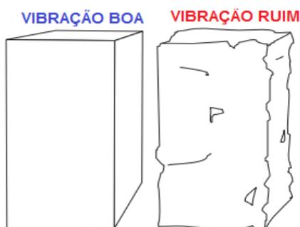
**Figura 29 – Influência da Vibração no concreto.**
