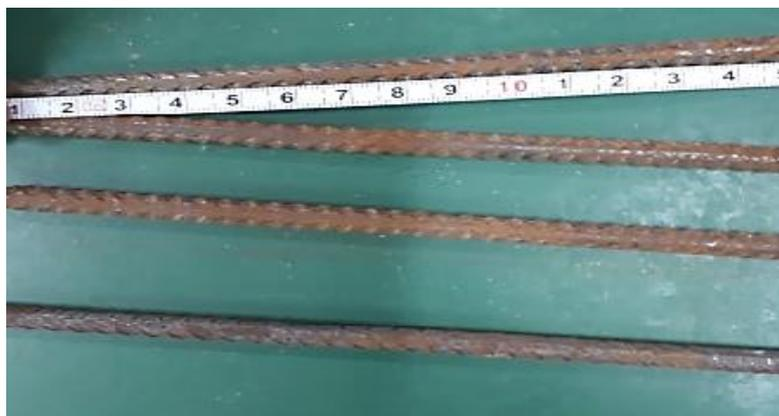
Figura 24 - Preparação de corpos de prova para ensaios de compressão axial.
