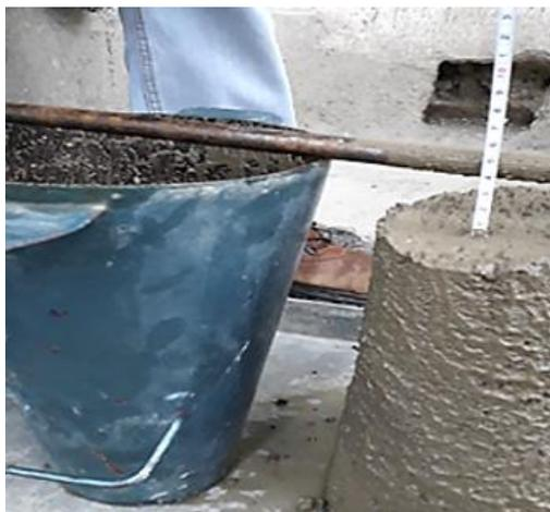
**Figura 28 - Slump test para análise da consistência do concreto fresco.**
