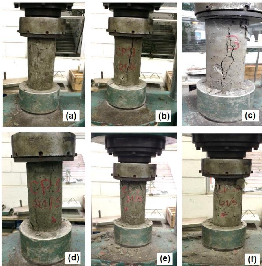
Figura 46 - Tipos de rupturas nos corpos de prova. (a) Cônica e cisalhada no CP. (b) Cônica no CP. (c) Cônica e bipartida no CP. (d) Colunar no CP. (e) Cônica e bipartida no CP. (f) Cisalhada.
