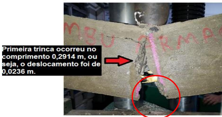
Figura 79 - Primeira trinca na armação com ripa de bambu.
