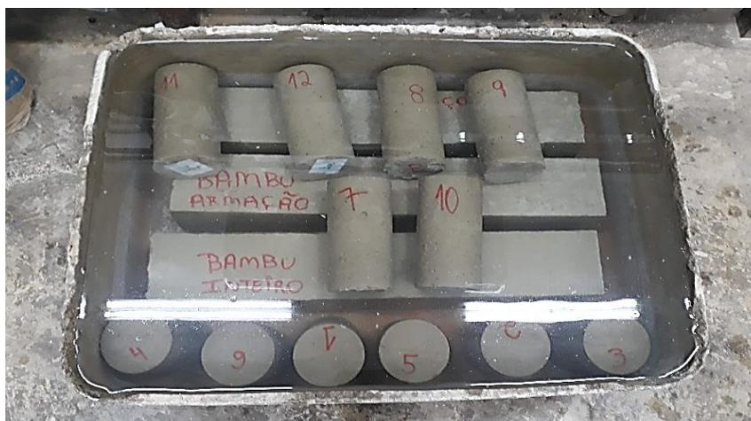
Figura 32 – Tanque de cura por imersão.
