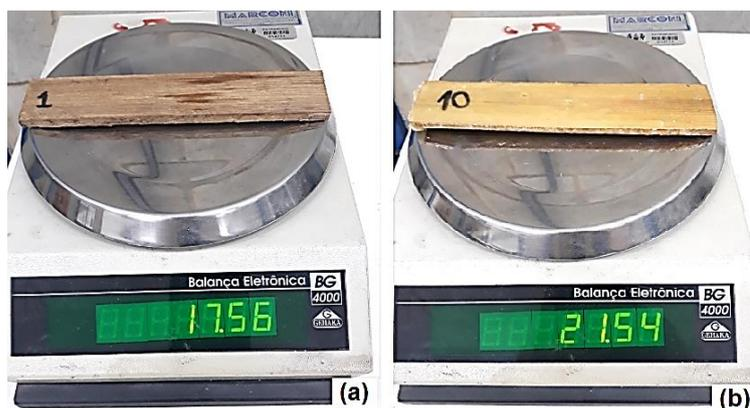
**Figura 23 - Pesagem dos corpos de prova: (a) Sem a resina vegetal de mamona. (b) Com a resina vegetal de Mamona.**
