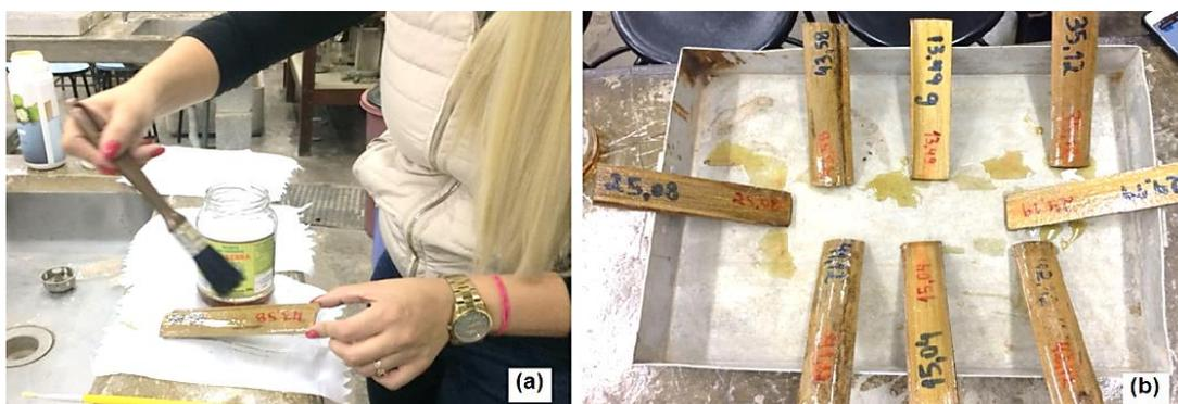
**Figura 22 - Aplicação da Resina Vegetal de Mamona. (a) Processo de aplicação da resina nos CPs. (b) Armazenamento e espera do tempo de secagem dos CPs.**
