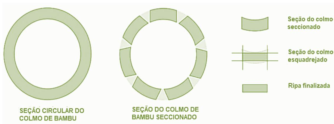
**Figura 18 – Processamento da ripa de bambu.**
