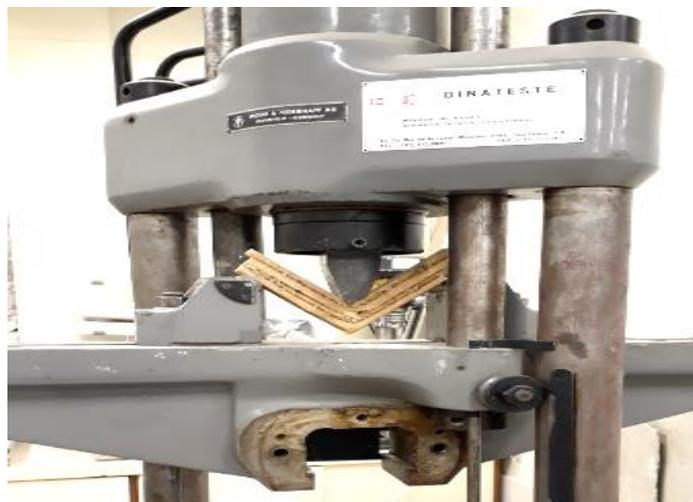
**Figura 12 - Limite plástico do bambu em ensaio de fibra.**
