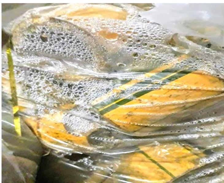
Figura 21 – Bambu em processo de exsudação.
