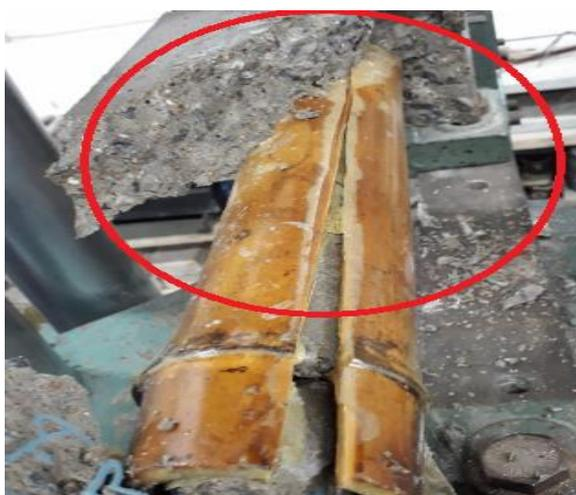
**Figura 84 - Rompimento na fibra do bambu.**
