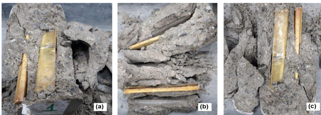
**Figura 52 - Corpos de prova ensaiados com estruturas internas de ripas de bambu Mosô impermeabilizadas: (a) Aderência dos CPs com o concreto. (b) Fragmentação dos CPs para observação interna das ripas. (c) Integridade do concreto combinado as estruturas de ripas.**
