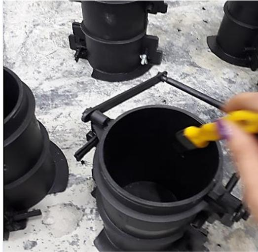
**Figura 30 - Aplicação de óleo mineral na forma cilíndrica.**
