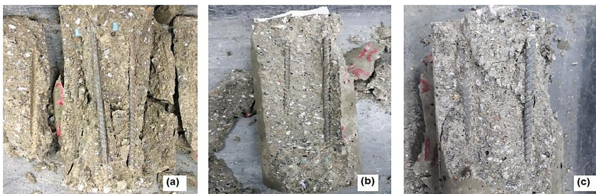
**Figura 50 -** Corpos de prova ensaiados com estruturas internas de aço CA 50: (a) estruturas do aço fixas na abertura do concreto. (b) Aderência perfeita (concreto e aço). (c) Nervuras do aço e relação de aderência.
