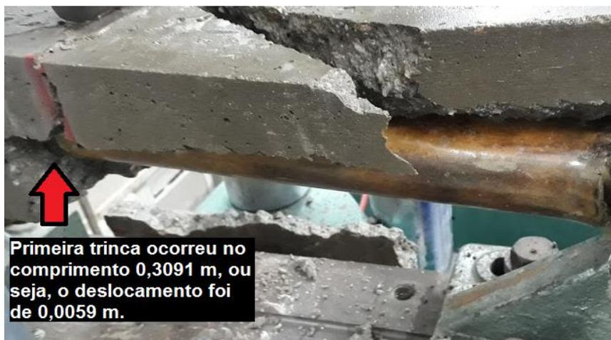
**Figura 83 - Primeira trinca na armação bambu inteiro.**
