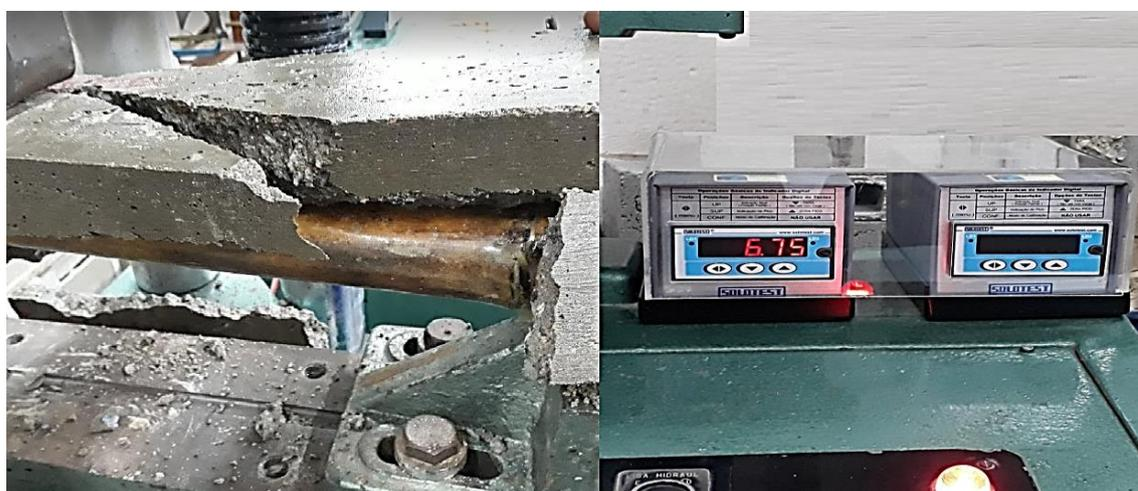
**Figura 68 - Rompimento da viga de concreto gramíneo com vara de bambu.**
