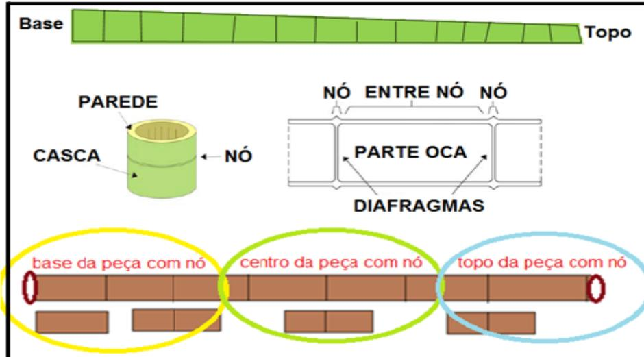
Figura 56 - Formato cônico da vara de bambu, selecionada para ensaio de compressão.
