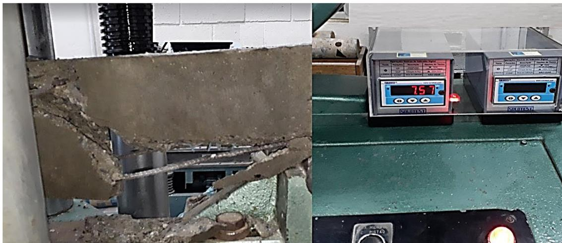
**Figura 67 - Rompimento da viga de concreto armada.**
