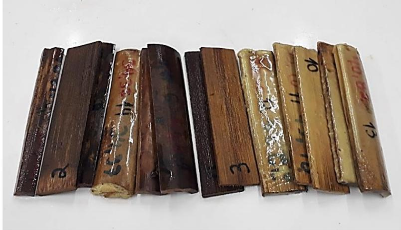
**Figura 34 - Corpos de Prova em ripa após imersão em água por 96 horas.**
