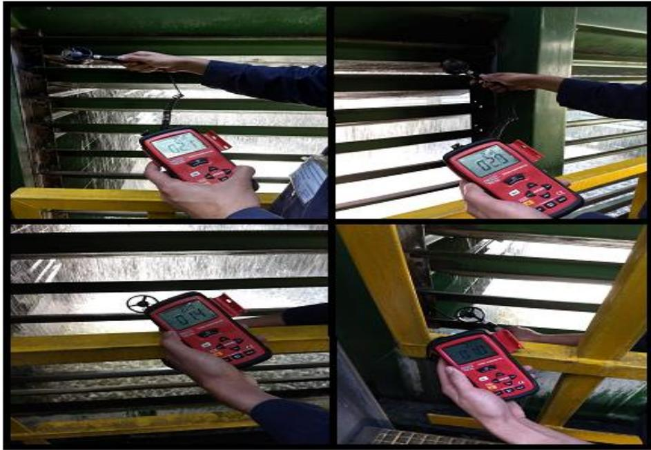
**Figura 41 - Coleta de velocidade do ar ocorrendo na entrada das venezianas das torres.**
