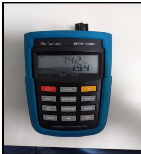
Figura 30 – Termo higrômetro utilizado no experimento.
