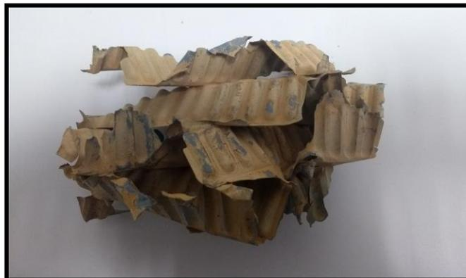
**Figura 36 - Pedaço de enchimento sem incrustação das torres estudadas.**
