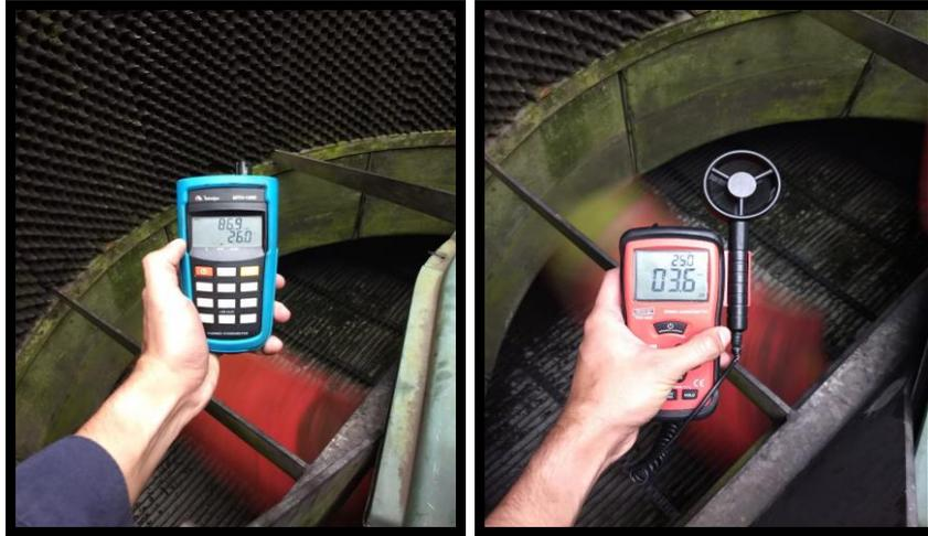
**Figura 43 – Termo higrômetro a esquerda e Termo anemômetro a direita, utilizados na saída de ar das torres.**
