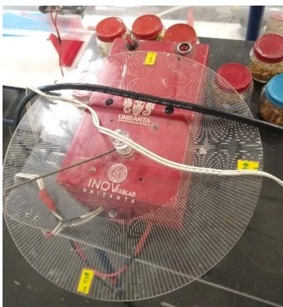
Figura 17 - Controlador de velocidade do alimentador da Unidade Piloto (AUTOR, 2022)
