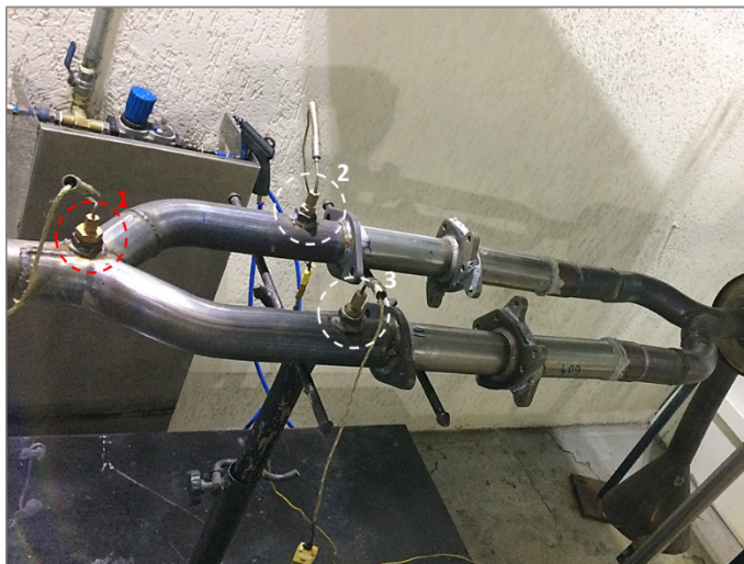
Figura 22 - Pontos de medições do ensaio de Fadiga Térmica.
