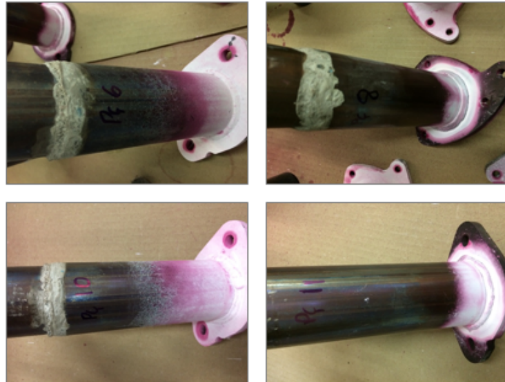
Figura 43 - Ensaio de Líquido Penetrante.
