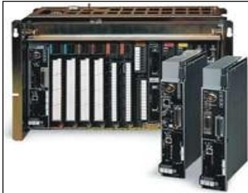
Figura 12. Imagem de um CLP da marca Rockwell (BUENO, 2012).
