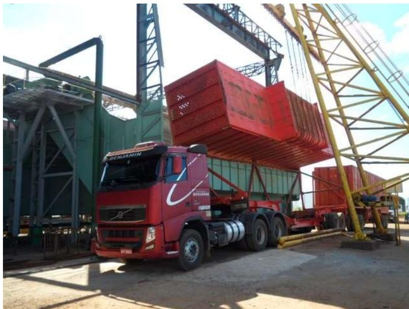
**Figura 1 – Descarregamento de matéria prima - cana-de-açúcar**
