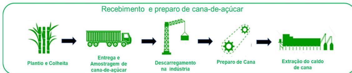
**Figura 2 – Fluxograma simplificado do recebimento e preparo da cana-de-açúcar**
