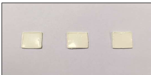
Figura 2.11 – CP em aço-carbono AISI 1010 (dimensões: 2,0 cm X 2,0 cm X 0,1 cm)
