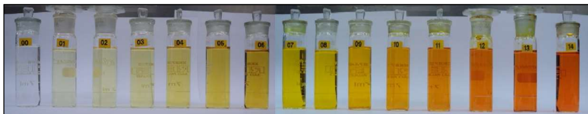
Figura 2.13 – Padrões de cor utilizados na determinação da cor do ácido de lavagem (ASTM D848)
