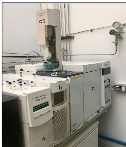
Figura 2.8 – Cromatógrafo acoplado ao espectrômetro de massas: (a) e (b) espectrômetro de massas; (c) cromatógrafo; (c1) amostrador; (c2) injeção de amostra; (c3) painel de controle
