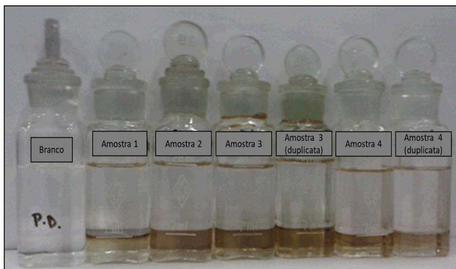
Figura 3.2 - Cor do ácido de lavagem fora de especificação (>1+) – benzeno no Tanque I
