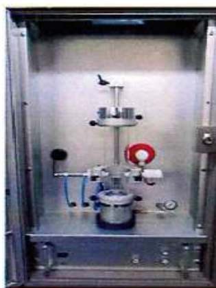
Figura 8: equipamento para ensaio da EMI (Mike 3). Fonte: Cetac (2016).
