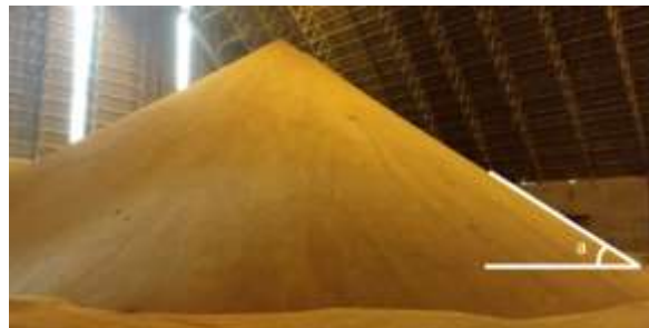
Figura 25: Vista geral da pilha de farelo de soja NGMO. E o ângulo de repouso a 0,6 m do solo. Fonte: Cardoso et.al (2020).
