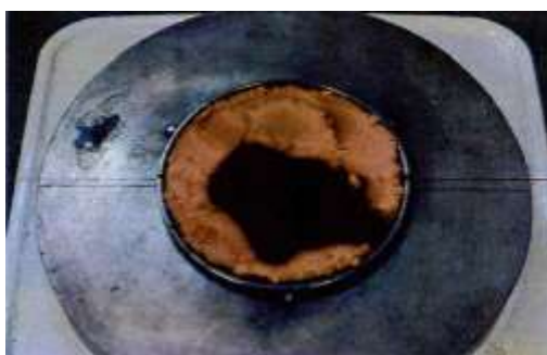
Figura 7: Poeira em combustão sobre superfície aquecida. Fonte: Cetac (2016).
