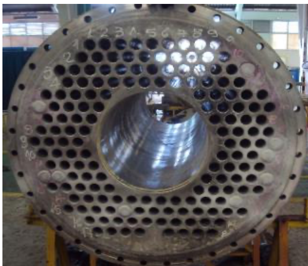
Figura 3- Feixe tubular trocador de calor com tubos plugados
