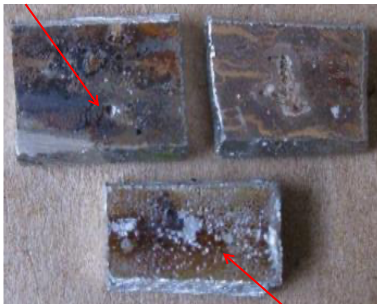
Figura 28- Amostras da superfície interna do tubo de purga presença de camada marrom
