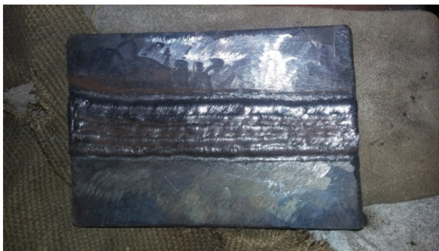
Figura 17: Chapas soldadas pelo processo MMA para confecção dos corpos de prova. (Fonte: autor 2019)
