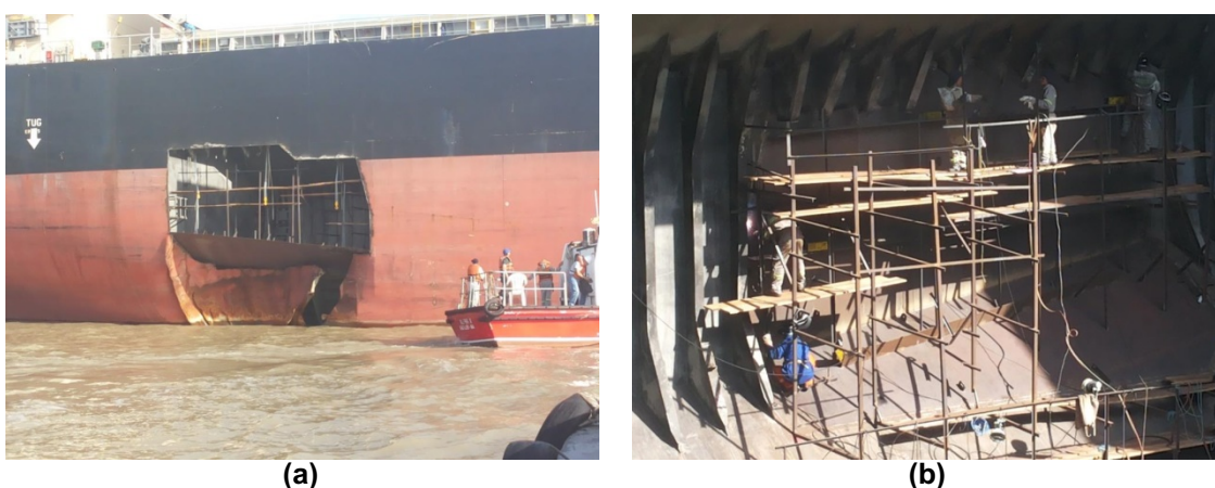
Figura 7: (a) Exemplo de reparos em casco- colisão e (b) imagem interna de reparos em casco- colisão. Fonte: autor (2019).
