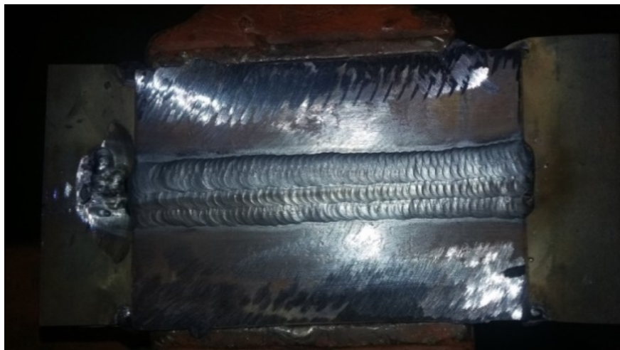
Figura 20: Chapas soldadas pelo processo TIG para confecção dos corpos de prova. Fonte: autor (2019)
