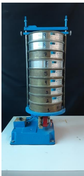
Figura 7 - Peneiras no vibrador.
