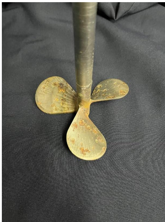
Figura 5- Impulsor naval com 3 pás
