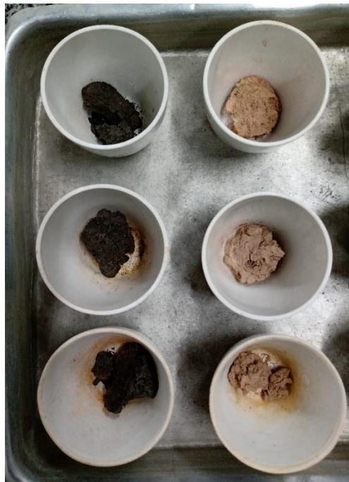
Foto 6: Cadinhos de cerâmica contendo as amostras de sedimento antes da queima em mufla (esquerda) e após a queima de matéria orgânica em mufla (direita). Fonte: Elaborado pelo autor.
