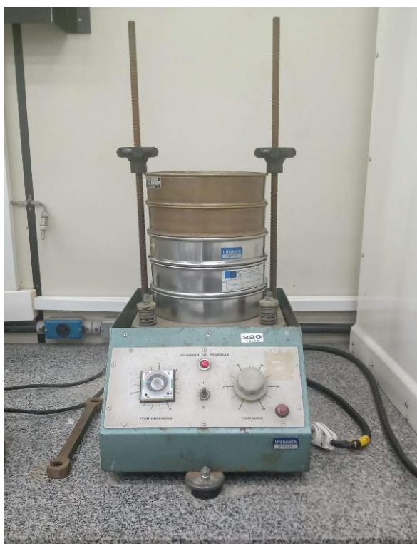
Foto 5: Conjunto de peneiras granulométricas no tamizador para separação do sedimento seco em categorias para determinação granulométrica. Fonte: Elaborado pelo autor.
