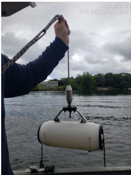
Foto 1: Amostragem de água subsuperficial com garrafa Van Dorn de 3 litros. Fonte: Elaborado pelo autor.
