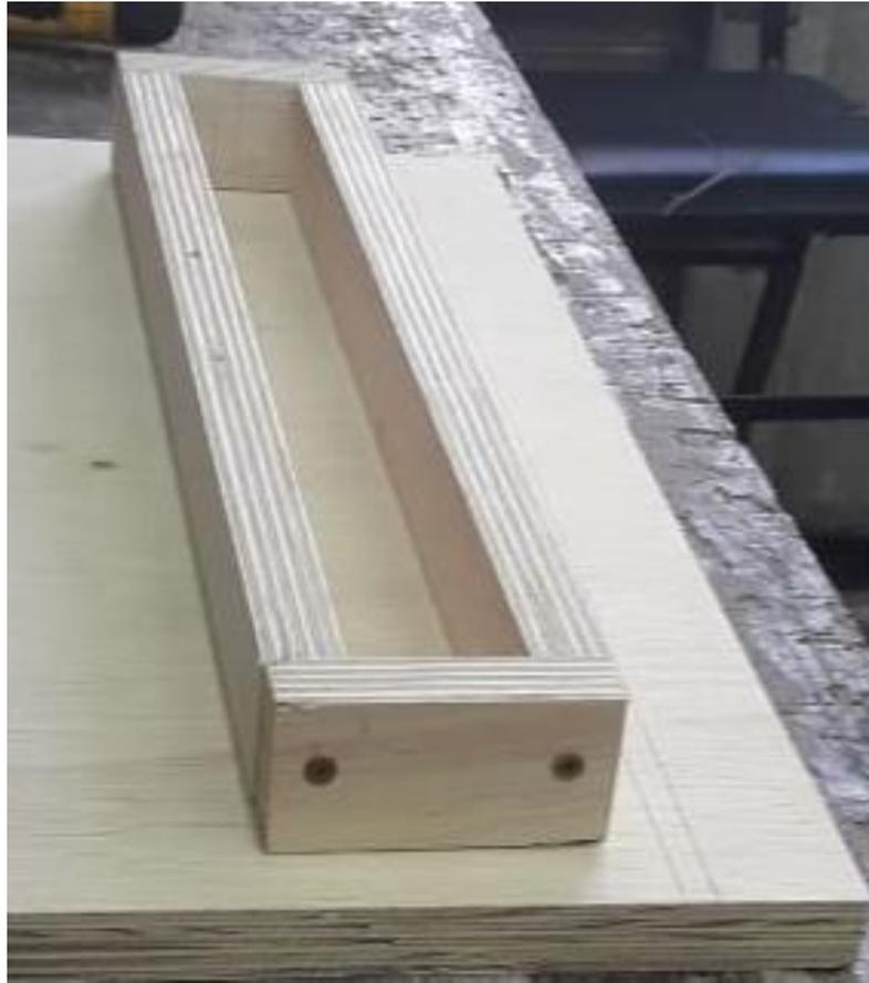
Figura 10 – Forma para tração e flexão
