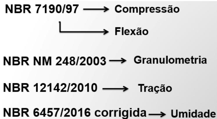
Figura 7 – Fluxograma dos Ensaios
