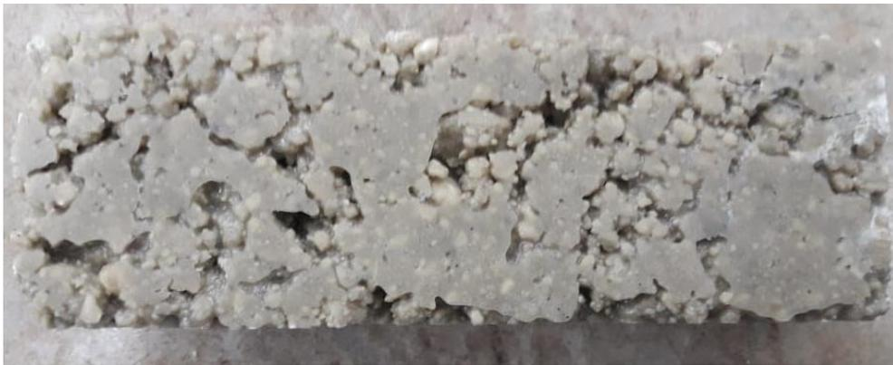
Figura 13 – Corpo de Prova do Ensaio Preliminar com 70% de Fosfogesso
