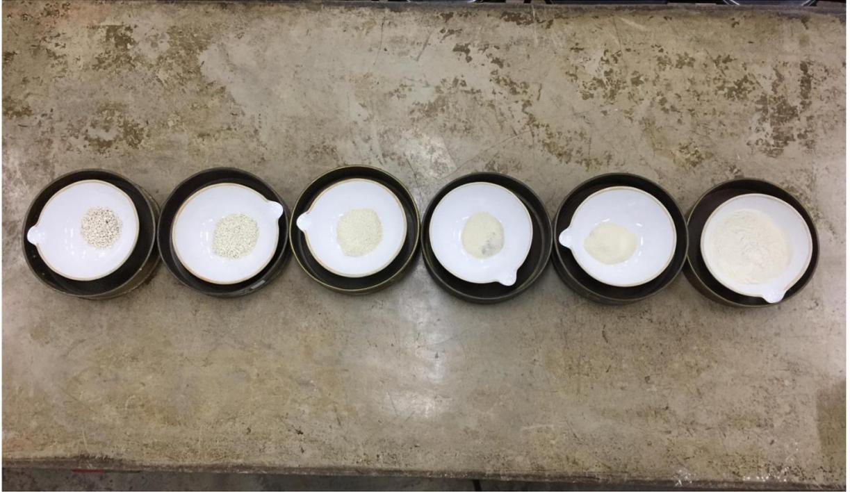
Figura A 3 – Fosfogesso retido nas peneiras
