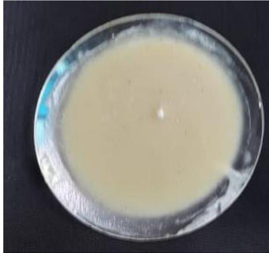
Figura 9 - Resina epóxi misturado com seu catalisador e o fosfogesso
