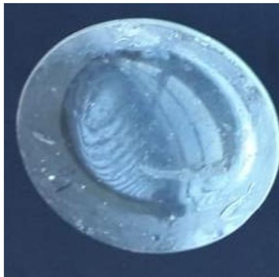
Figura 8- Resina epóxi misturado ao catalisador
