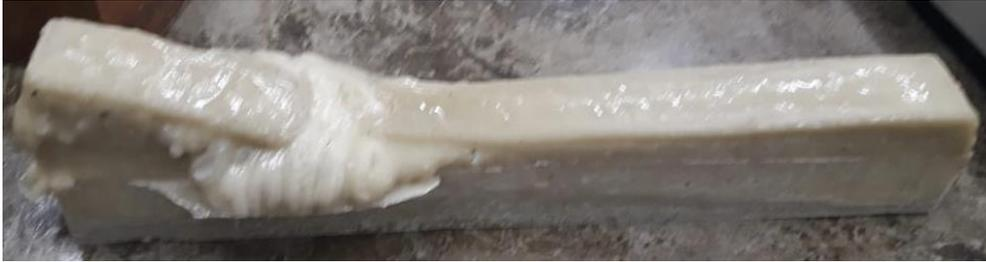
Figura 12 – Corpo de Prova do Ensaio Preliminar com 30% de Fosfogesso
