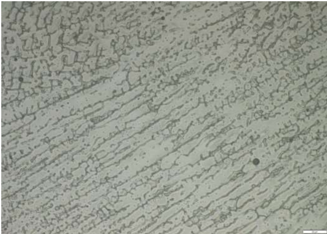
Figura 23 - Microestrutura da ZTA no aço 316L e cordão de solda no corpo de prova 01. Aumento de 500X e ataque Marble.
