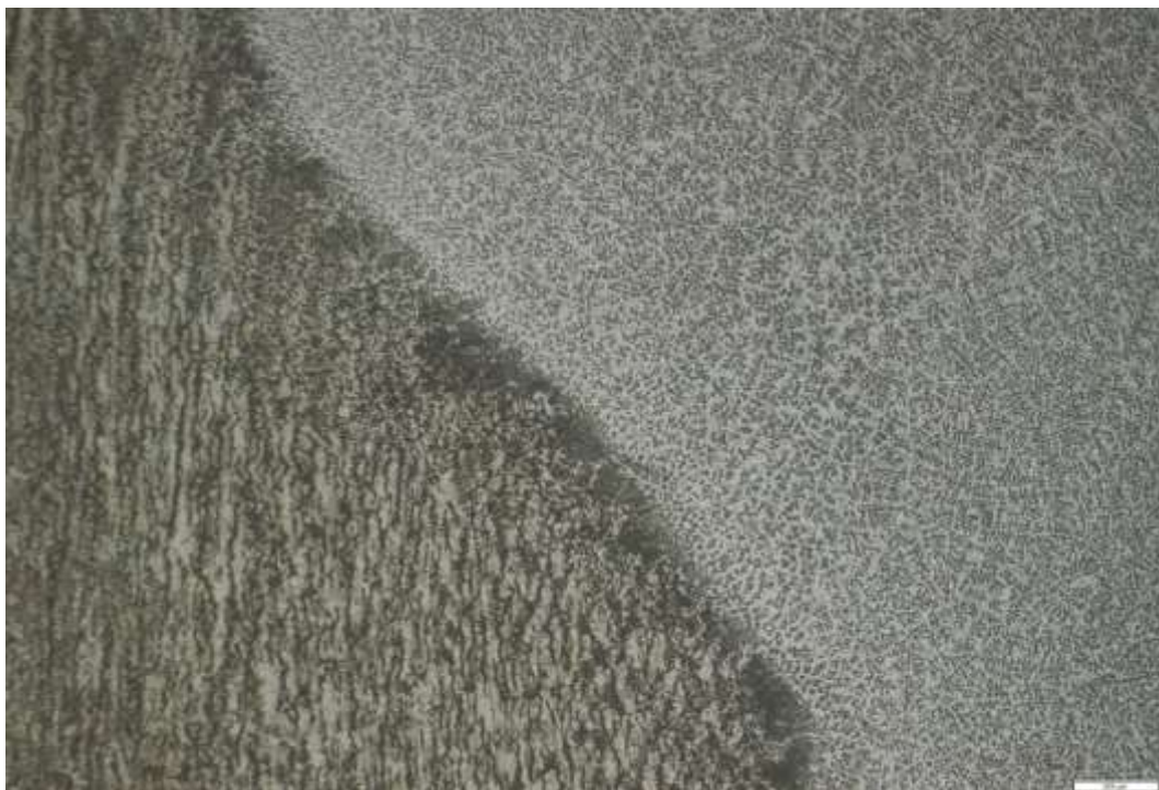
Figura 24 - Microestrutura da ZTA no aço 316L e cordão de solda no corpo de prova 02. Aumento de 500X e ataque Marble.
