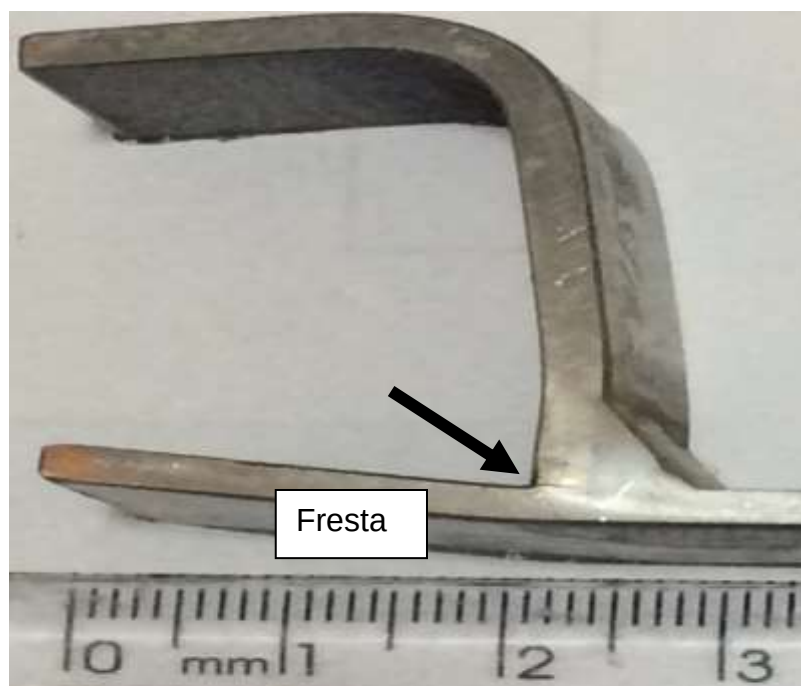
Figura 39 - Fresta localizada entre a câmara interna e externa
