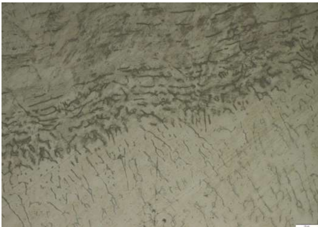
Figura 29 - Microestrutura da ZTA no aço 316L e cordão de solda no corpo de prova 03. Aumento de 500X e ataque Marble.
