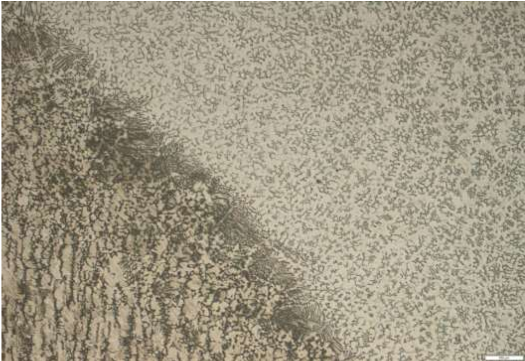
Figura 25 - Microestrutura da ZTA no aço 316L e cordão de solda no corpo de prova 02. Aumento de 100X e ataque Marble.
