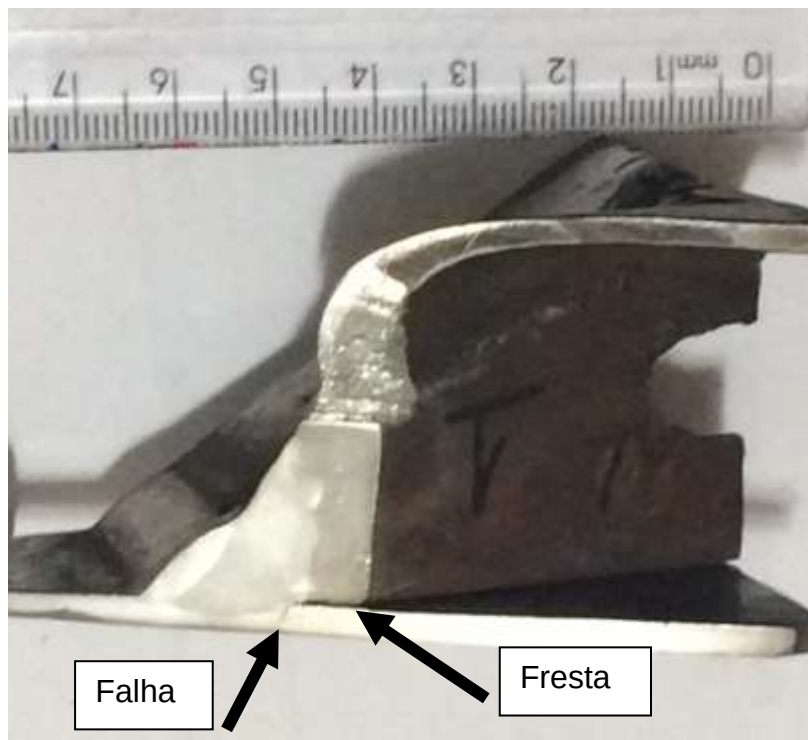
Figura 38 - Fresta e falha localizadas na câmara interna no CP 01.
