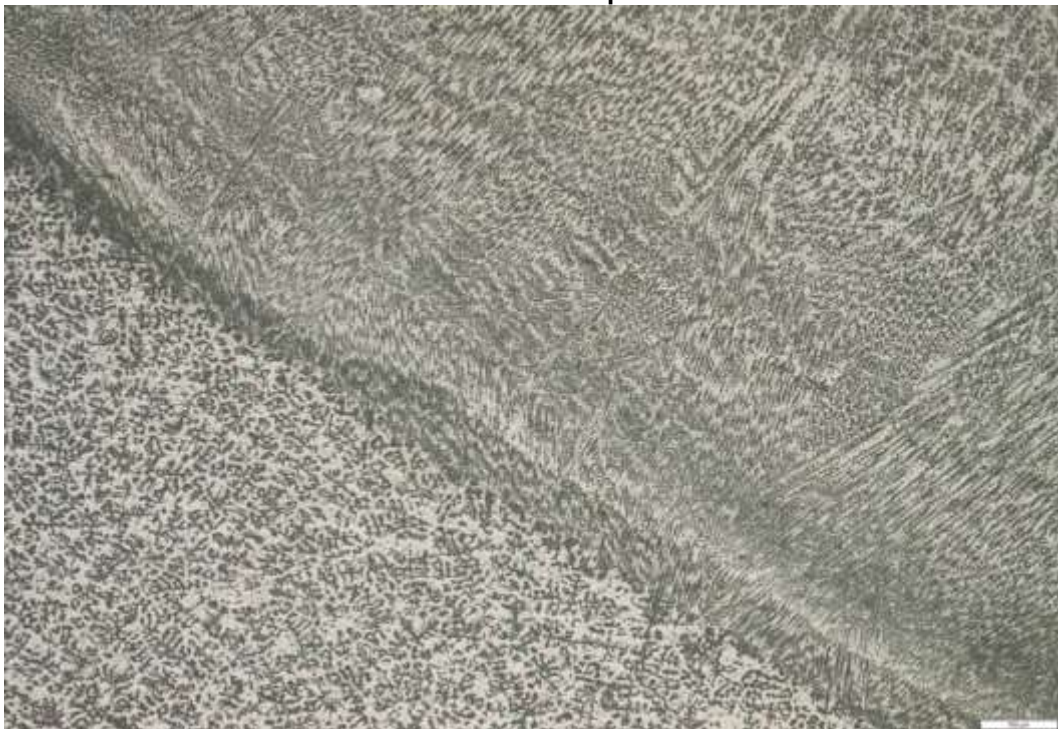
Figura 22 - Microestrutura da ZTA no aço 316L e cordão de solda no corpo de prova 01. Aumento de 100X e ataque Marble.
