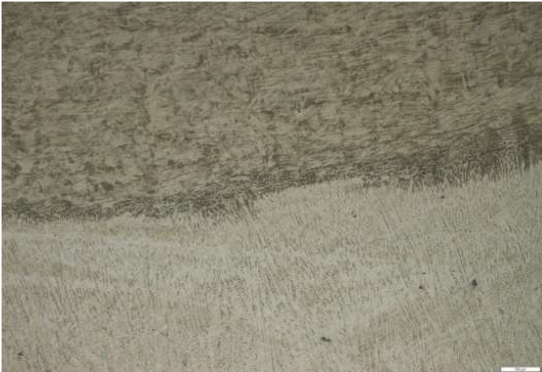
Figura 28 - Microestrutura da ZTA no aço 316L e cordão de solda no corpo de prova 03. Aumento de 100X e ataque Marble.
