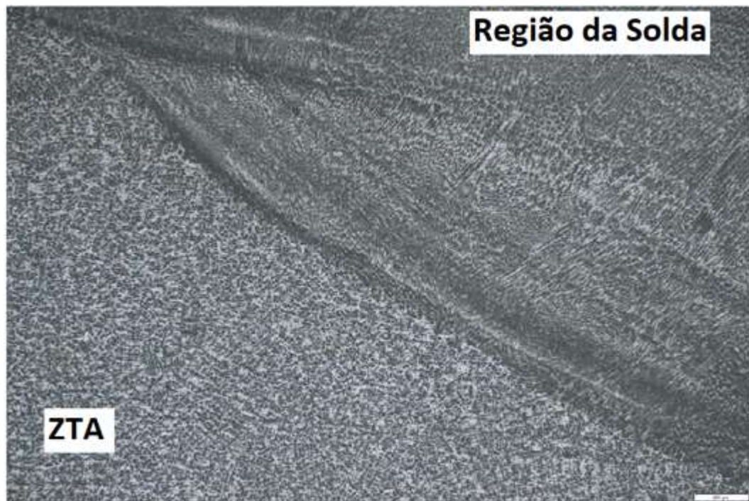
Figura 21 - Microestrutura da ZTA no aço 316L e cordão de solda no corpo de prova 01. Aumento de 50X e ataque Marble.
