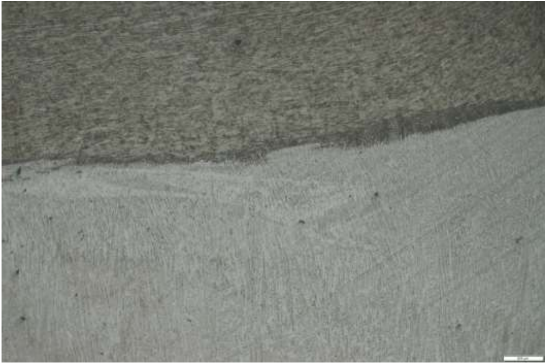
Figura 27 - Microestrutura da ZTA no aço 316L e cordão de solda no corpo de prova 03. Aumento de 50X e ataque Marble.
