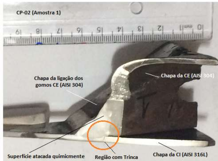
Figura 14 - Amostra obtida para caracterização metalográfica e análise do perfil de dureza.
