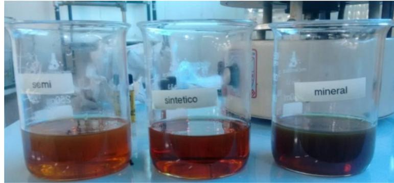
**Figura 4 – Disposição dos óleos nos béqueres, semissintético, sintético e mineral respectivamente.**
