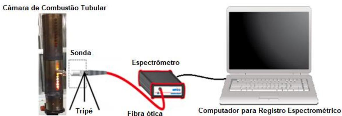
**Figura 8** - Aparato para realização experimental da queima de biomassa e sistema de espectrometria
