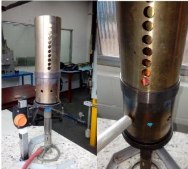
**Figura 6** - Câmara de combustão tubular
