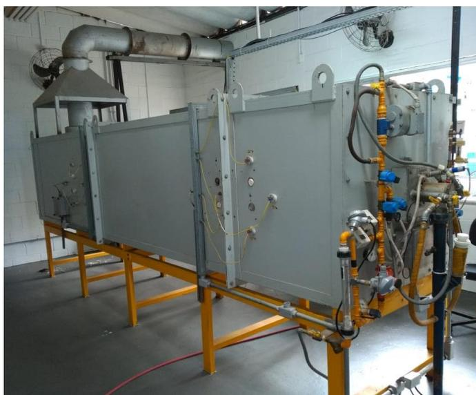
**Figura 12** - Forno tipo túnel movido a gás GLP e óleo diesel
