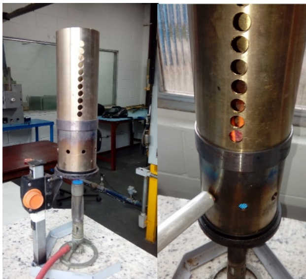
Figura 11 – Câmara de Combustão Experimental
