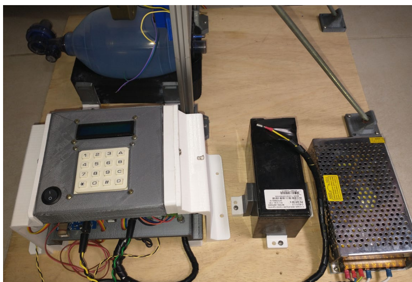
Figura 39 - Estrutura eletrônica desmontada, com sistema de fonte e bateria.
