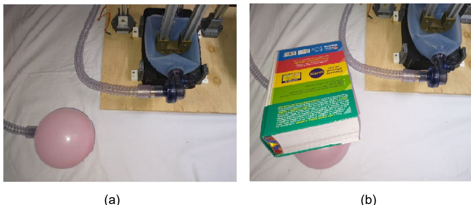
Figura 51 - Teste de carga com balão de ensaio. (a) sem carga. (b) com aplicação de carga de 2,2 Kg.
