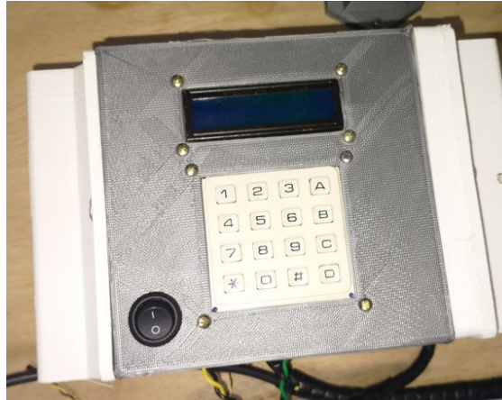
Figura 36 - Sistema eletrônico e caixa de suporte.
