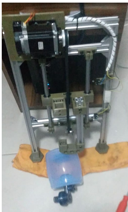
Figura 41 – Protótipo inicial através de polia/correia do tipo GT2.
