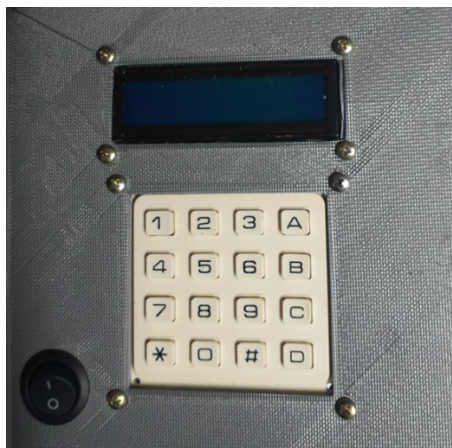
Figura 9 - Conjunto de interação com o usuário, a esquerda, botão de entrada do menu, a direita, teclado e display 16x2.
