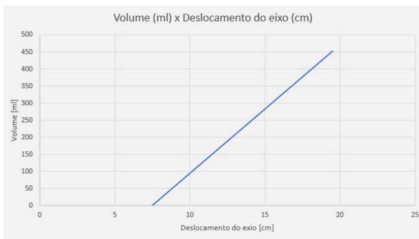
Figura 49 - Volume [ml] x deslocamento do impulsor do reanimador pulmonar manual [cm].
