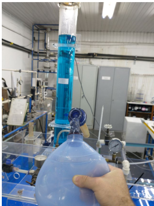
Figura 48 - Medição da capacidade volumétrica do reanimador pulmonar manual.
