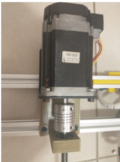
Figura 32 - Montagem do motor, fuso, acoplamento e suporte do motor.
