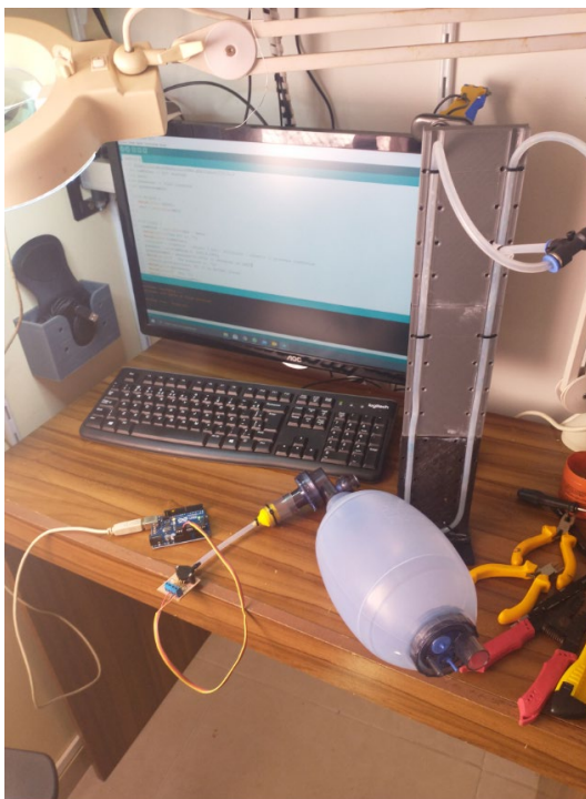
Figura 45 – Reanimador pulmonar manual e testes de pressão tubo em "U".
