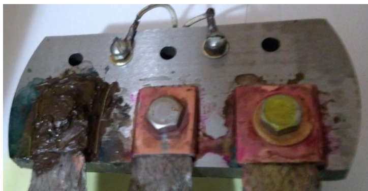
Figura 61 - Início do terceiro experimento ponto de conexão com a pasta.
