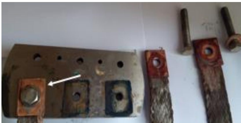
Figura 69 - Quarto experimento retirado a pasta do terceiro ponto de conexão.
