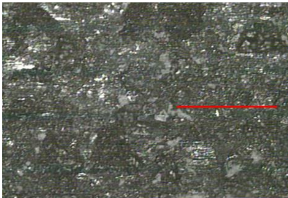
Figura 72 - Corrosão agressiva em Ponto de conexão com arruela de latão.
