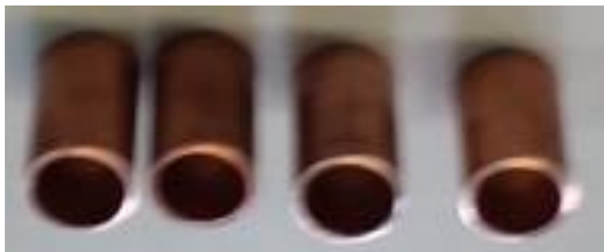
Figura 24 - Tubos para confeccionar terminais.
