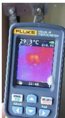
Figura 41 - Medição de temperatura com o Termovisor com pasta.
