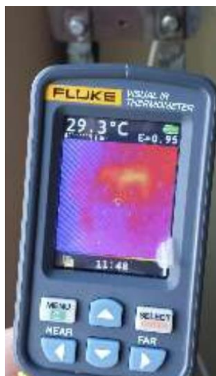
Figura 40 - Medição de temperatura com o Termovisor sem pasta.
