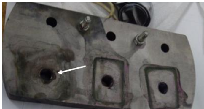
Figura 60 – Sem parafuso e arruela de latão.
