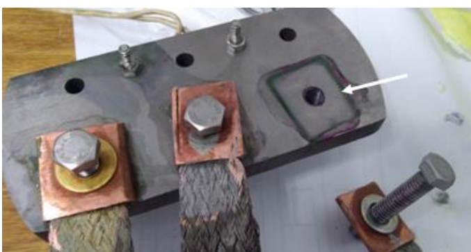
Figura 58 - Conexão com arruela de aço e parafuso.
