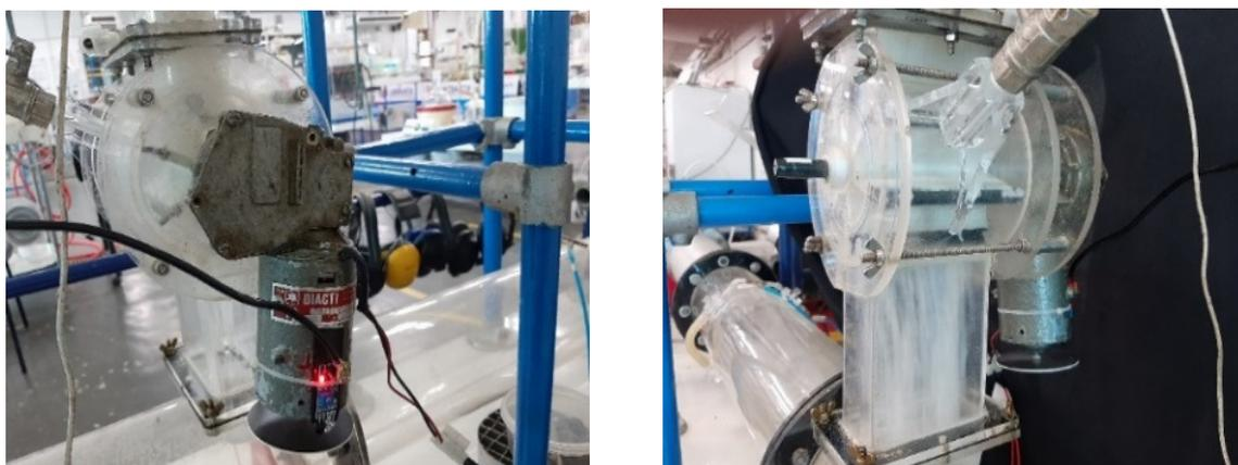
**Figura 31 – Sensor de rotação (rpm) com o disco de rotação acoplado no motor**
