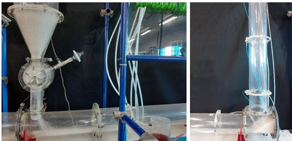
**Figura 35 – Potenciômetro no ponto intermediário – Frequência = 30Hz. Polietileno deslocado na parte inferior do duto horizontal.**
