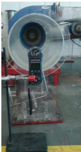
**Figura 27 – Anemômetro instalado no bocal de sucção.**
