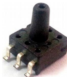
Figura 16 – Sensor de Pressão MPS20N0040D-D.
