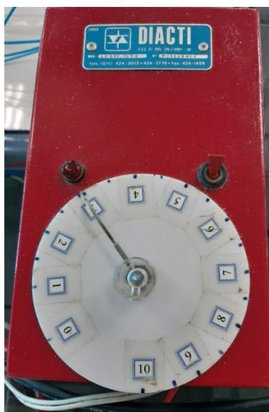
**Figura 13 – Potenciômetro controlador da válvula rotativa. .**
