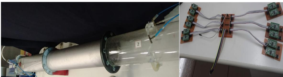
**Figura 30 – Mangueiras conectadas no pontos 1 e 2 de acrílico com diâmetro interno de 117mm para as leituras dos sensores de pressão de ar DIP (mmca) com os seus Módulos Conversores de Células de Cargas - HX711 para obtenção da velocidade de ar (m/s)**
