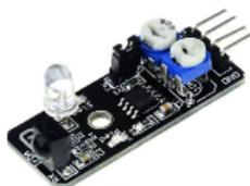
**Figura 18 – Sensor de Obstáculo Infravermelho IR – KY – 032.**
