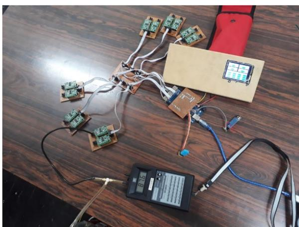
Figura 29 – Sensor de pressão com os Módulos Conversores de Células de Cargas - HX711
