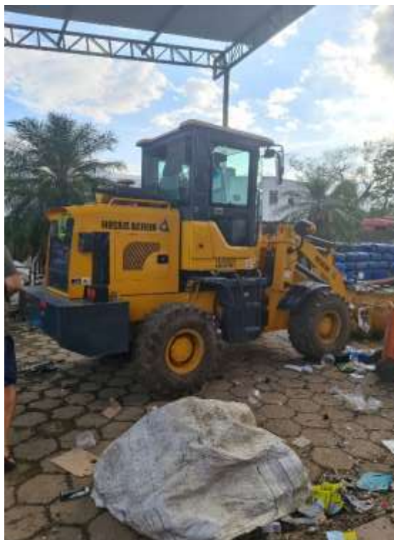
Figura 34 – Retroescavadeira - remoção dos resíduos recebidos para a área de segregação – COOP CUB 1. Fonte: Elaborado pelo autor.
