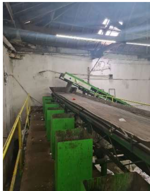
Figura 21 – Processo de segregação na esteira rolante –COOP SAN 2. Fonte: Elaborado pelo autor.
