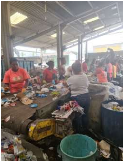
Figura 20 – Processo de segregação na esteira rolante – COOP PG 2. Fonte: Elaborado pelo autor.
