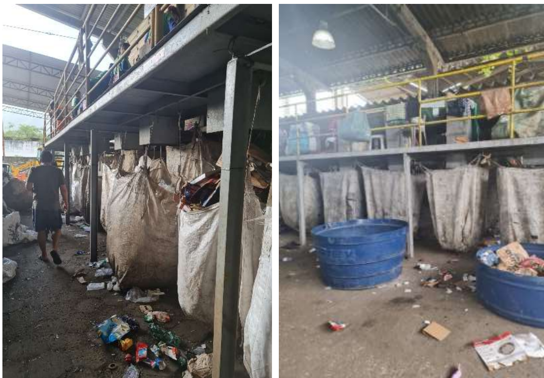
Figura 22 e 23 – Aberturas na parte debaixo das esteiras para direcionamento do resíduo separado.
