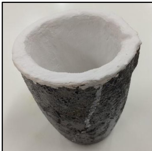
Figura 13 – Cadinho de carbeto de silício.
