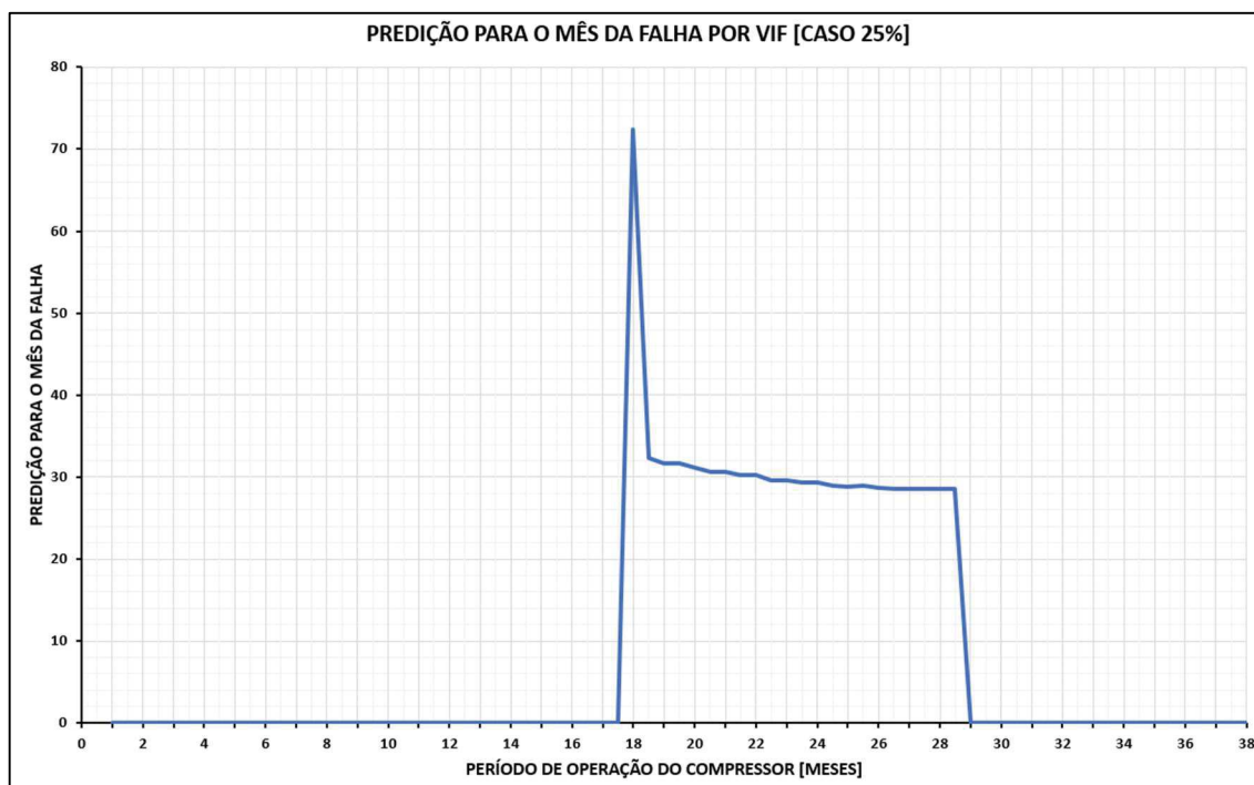
Figura 48 - Predição para o Mês em que Ocorrerá a Falha para o Caso 25%.
