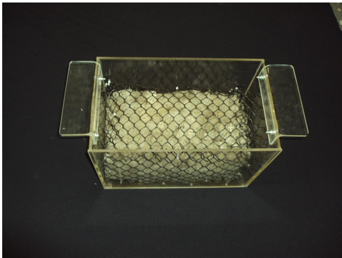
Figura 3.9 – Cesta pré-separadora com anéis Rashing de 1" em polipropileno.
