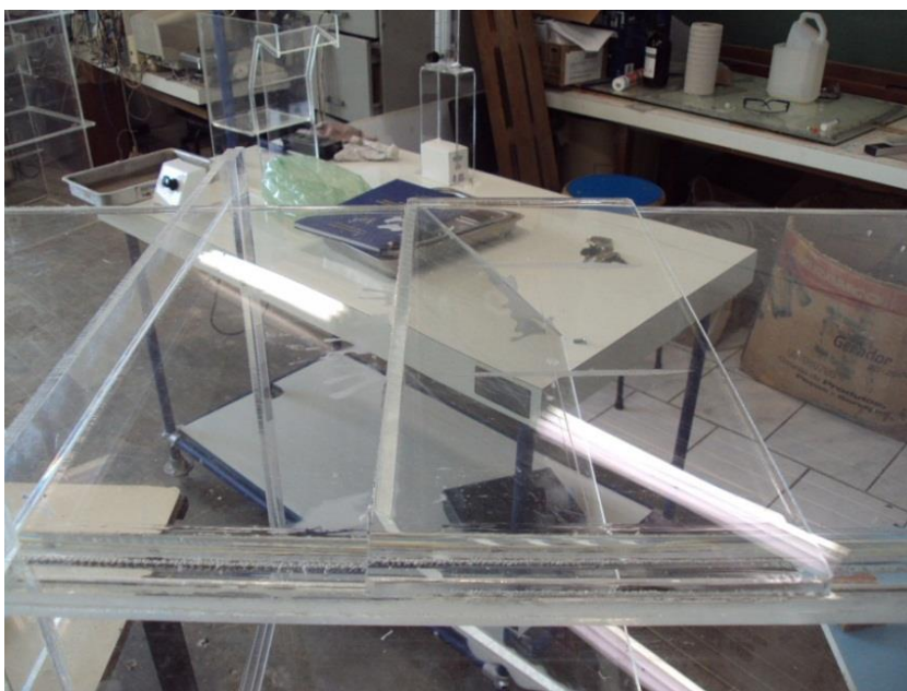
Figura 3.5 – Construção do tanque.
