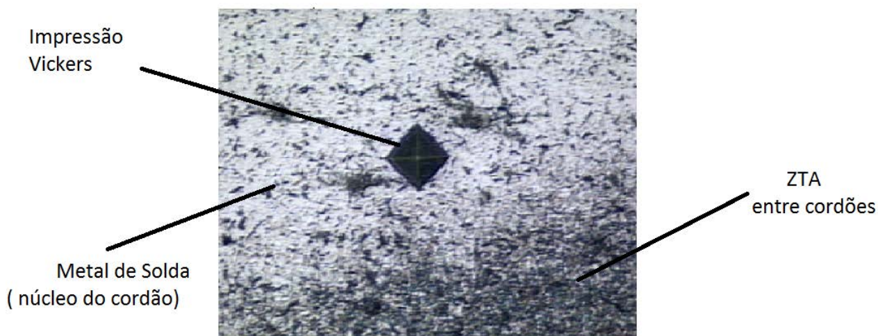
Figura 51 – Impressão da dureza vickers (5N) do corpo de prova, na região entre a ZTA e o centro de um cordão de solda.
