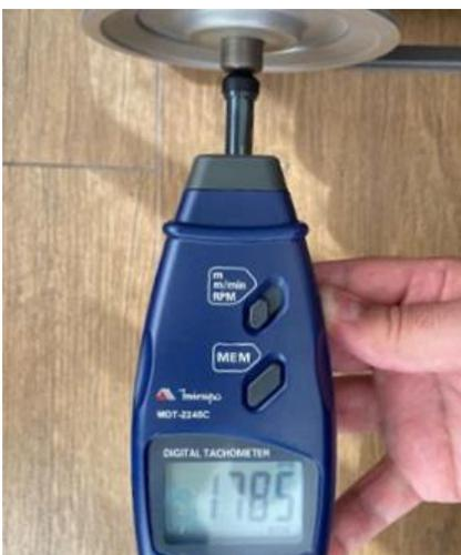
**Figura 16(a), RPM / Tacômetro**
