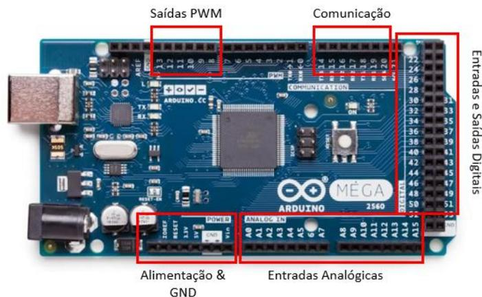
Figura 17: Pinagem Arduino Mega 2560
