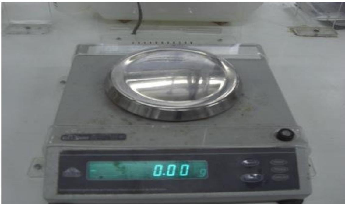
**Figura 28 – Balança de laboratório** – marca Marte – modelo AL 500 capacidade máx. de 500 g – carga mínima 0,02 g – divisão de verificação 0,01 g- classe II
