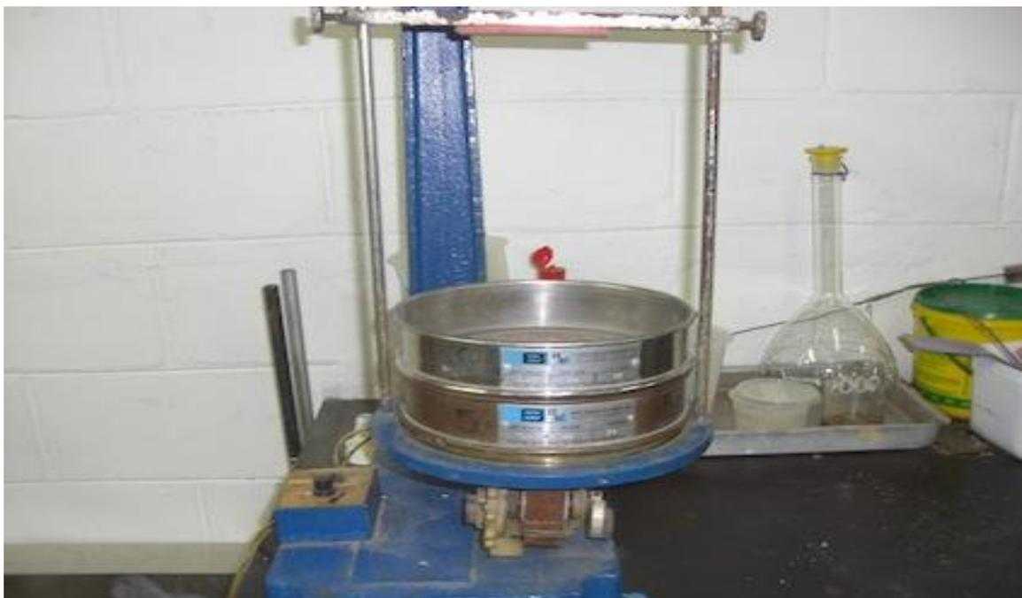
**Figura 29 – Equipamento vibratório de peneiramento** – marca Gehaka – modelo BG 2000, E capac. Máx. 2.000 g. Composto por 7 peneiras de malhas - # 32, #42, #50, #60, #100, #140, #200
