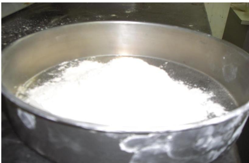
**Figura 14 – Ilustração do fosfogesso após a secagem e apassivação com carbonato de cálcio**
