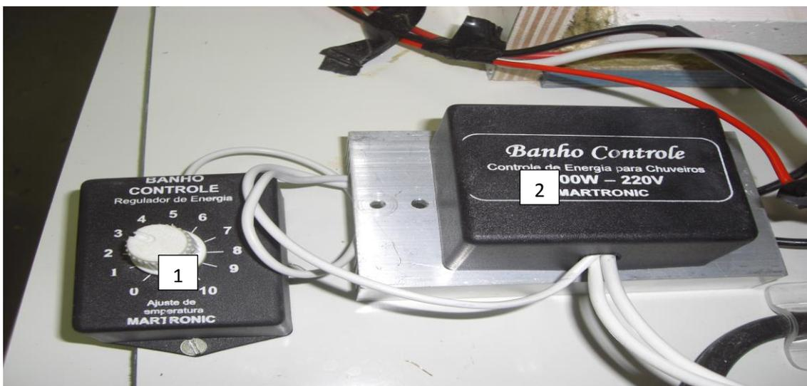
**Figura 12 - Ilustração do sistema elétrico para alimentação do experimento.** Composto por: (1) Potenciômetro para ajuste de temperatura; (2) Controle de energia.
