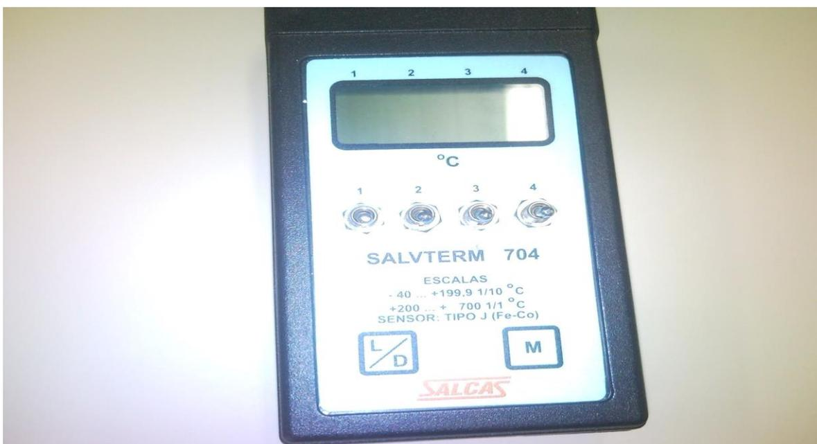
**Figura 22– Sensor de temperatura digital – marca salcas, mod. Salvterm 704, escala -40 a +700 °C, sensor tipo J (Fe – Co)**
