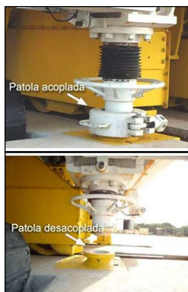
Figura 26 – Subsistema de ancoragem.
