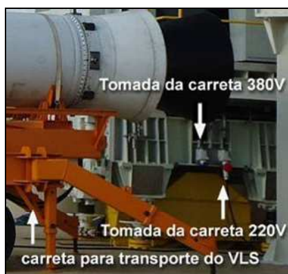
Figura 29 – Tomadas da carreta com sistema hidráulico.
