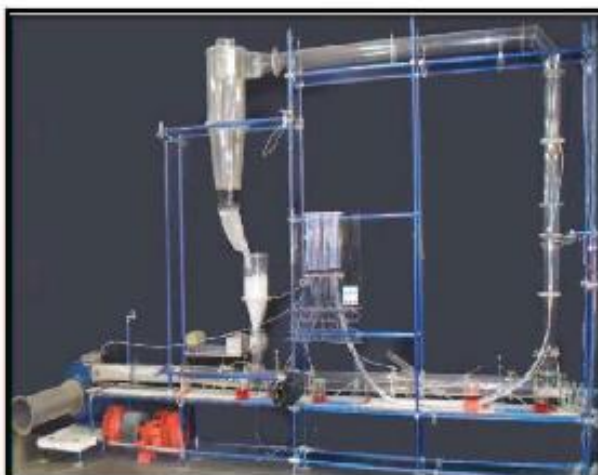
Figura 1 – Unidade Piloto de Transporte Pneumático Projetada e Instalada no laboratório de Operações Unitárias da Unisantia (Moraes, 2012)
