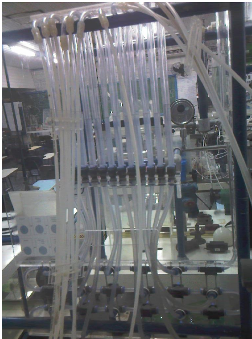
Figura 3.9 – Banco de Tubos em “U”
