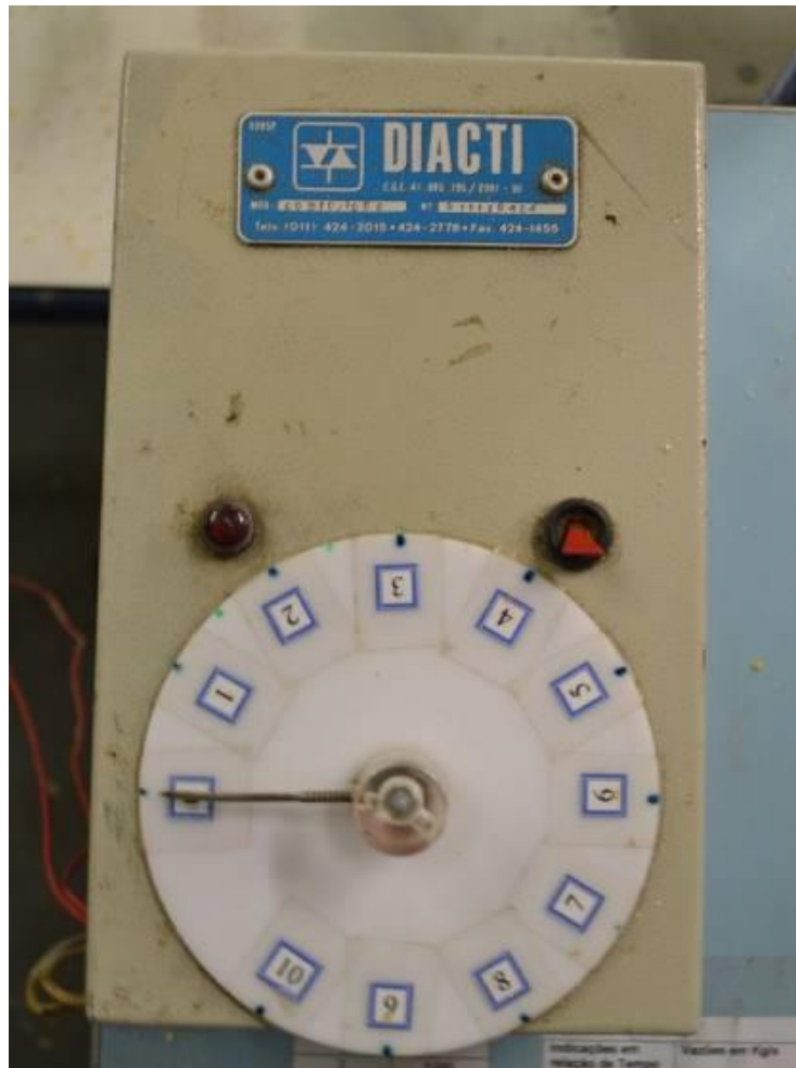
Figura 3.8 – Controlador de Velocidade do Motor da Válvula Rotativa
