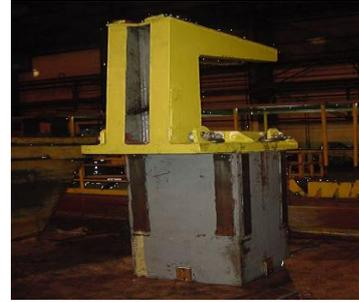
**Figura 2.7 - Carro elevador de bobinas**
