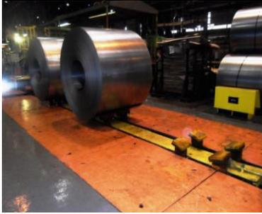
**Figura 2.6 - Esteira para transporte de bobinas**
