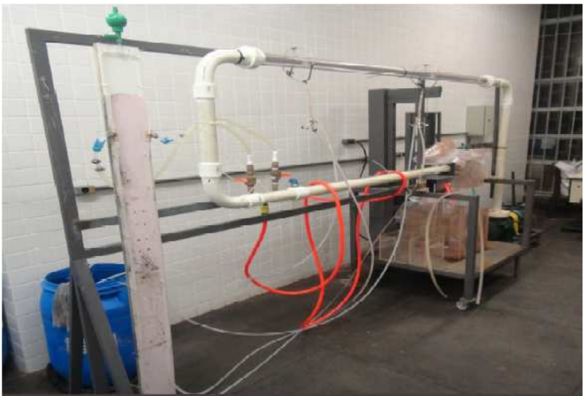
Figura 20 – Registro fotográfico da unidade experimental de bombeamento de polpas minerais com diâmetro de 50,8 mm. Fonte: SOUZA PINTO, 2012.
