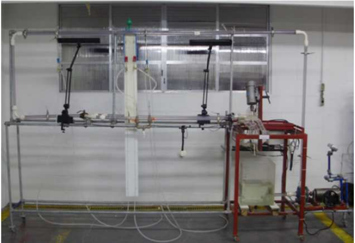
Figura 19 – Registro fotográfico da unidade experimental de bombeamento de polpas minerais com diâmetro de 25,4 mm. Fonte: SOUZA PINTO, 2012.
