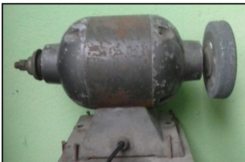
Figura 3.29 – Esmeril utilizado para entalhe das esferas.
