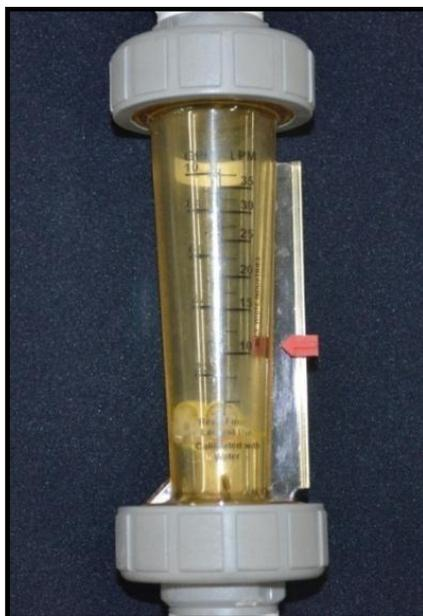
**Figura 3.15 – Rotômetro**
