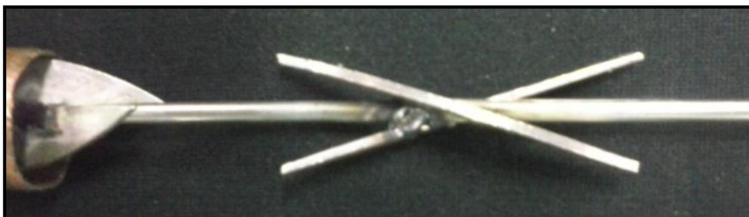
**Figura 3.20 – Detalhe dos módulos cruzados, fixados na haste de aço inox.**
