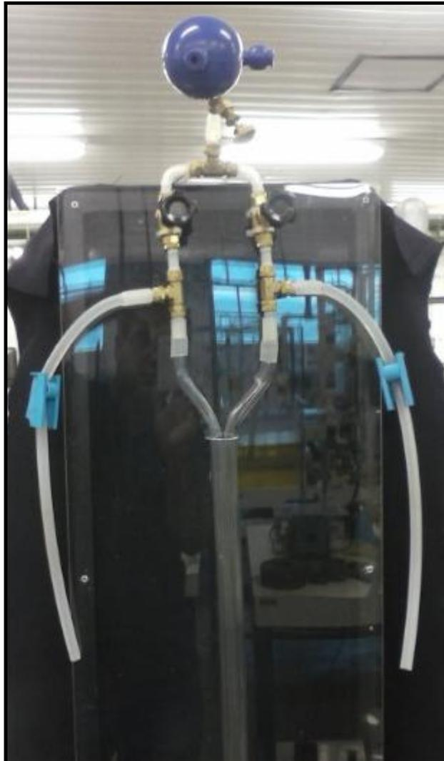
**Figura 3.17 – Piezômetro**
