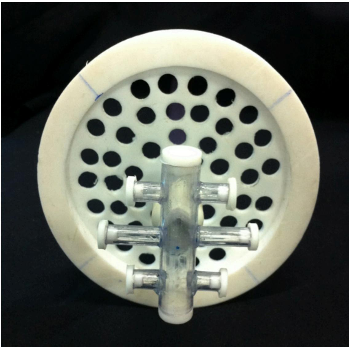
Figura 20 – Distribuidor de líquido tipo espinha de peixe acoplado ao espelho.
