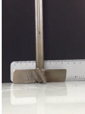
Figura 3.11 – Impelidor axial 4PBT45 utilizado (Fonte: Autor)
