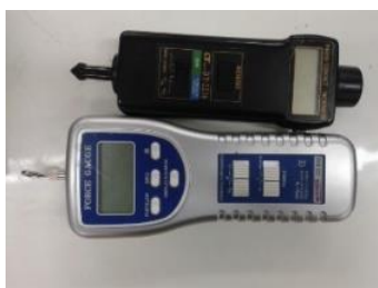
Figura 3.16 – Tacômetro e Dinamômetro (Fonte: Autor)
