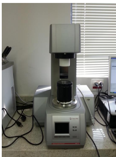
Figura 3.2 - Reômetro Anton Paar MCR 102 (Fonte: Autor)
