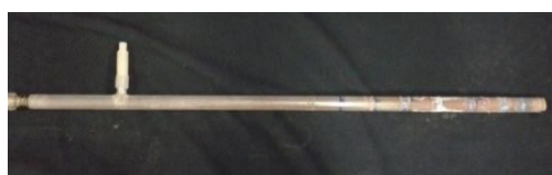
Figura 3.14 - Amostrador tipo pipeta (Fonte: Autor)
