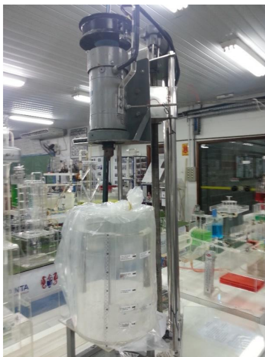
Figura 3.10 – Sistema de agitação mecânica sem draft tube carregado com sólido (Fonte: Autor)
