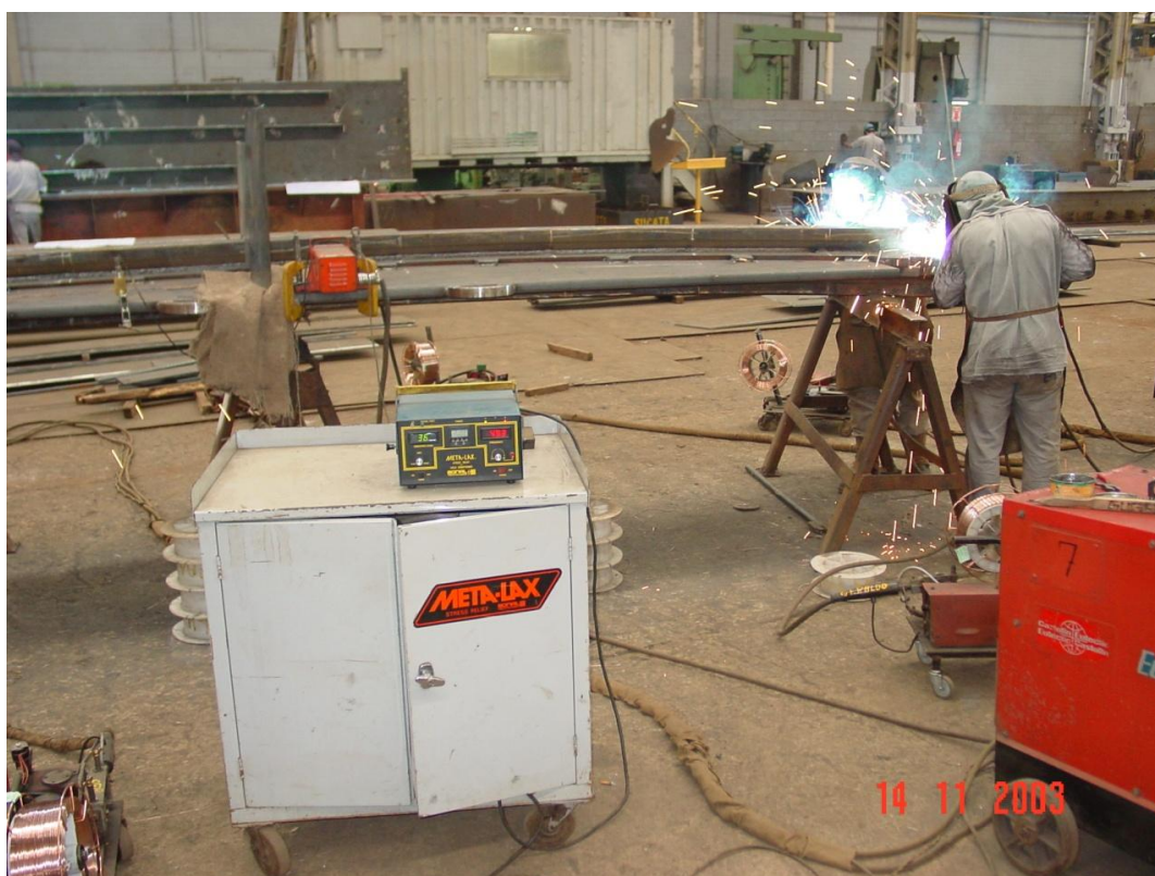
Figura 23 - Condicionamento de solda por vibrações sub-ressonantes
