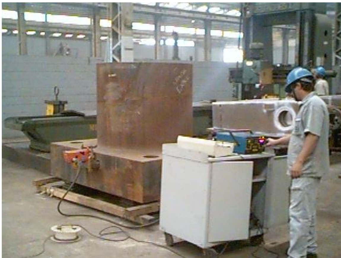
Figura 19 - Alívio de tensões por vibrações em peça apoiada sobre o solo.
