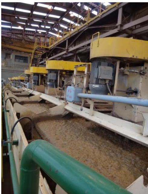
**Figura 7–Célula de flotação**
