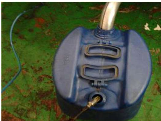
Figura 35 - Sonda do Analisador de Gases, instalado na descarga do DLGO.
