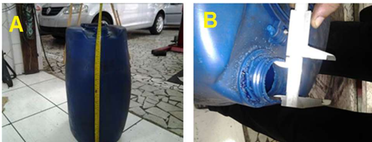
Figura 27 - A) Reservatório do DLGO, feito de bombona reutilizada. B) Detalhe do bocal de entrada do reservatório.
