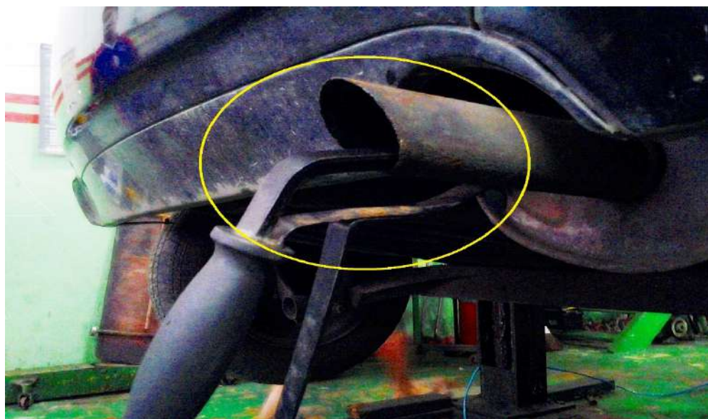
Figura 24 - Sonda do Analisador de Gases conectado diretamente no veículo.
