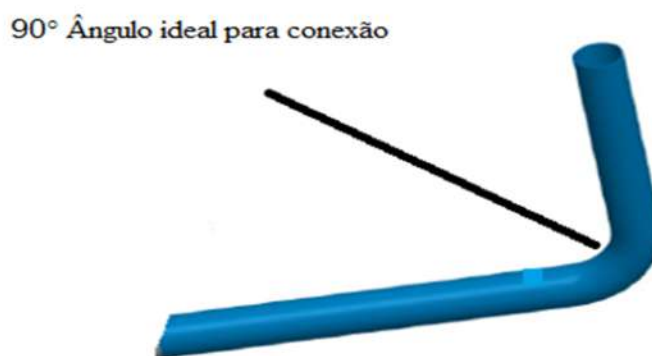
Figura 31 - Tubulação dobrada em ângulo de 90 ° para melhor aporte do contato entre o dispositivo e o escapamento veicular.
