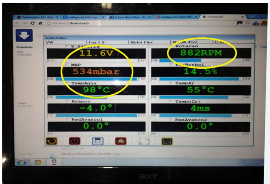
Figura 33 – Interface do programa scanner Tecnomotor monitorando o motor durante os experimentos.
