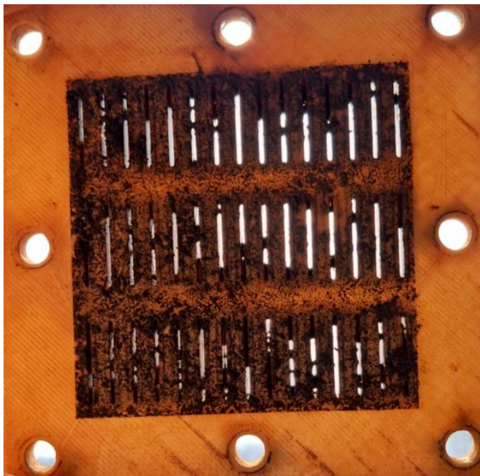
Figura 58 - Condição de dreno após ensaio com minério de ferro CFFZ.
