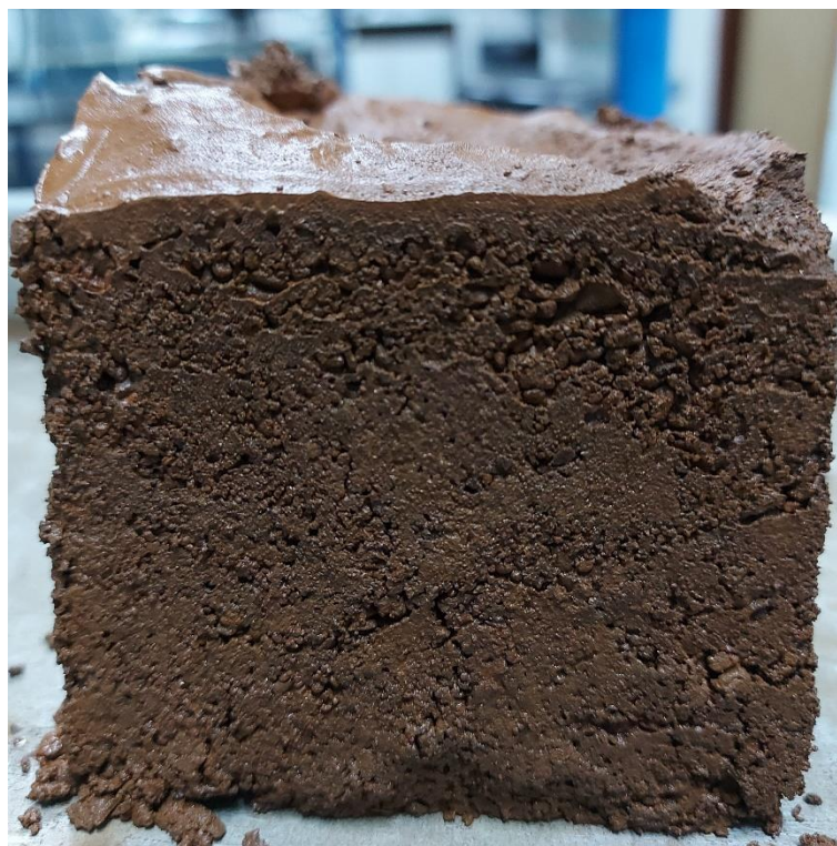
Figura 46 - Separação entre camada de deposição e corpo da amostra.
