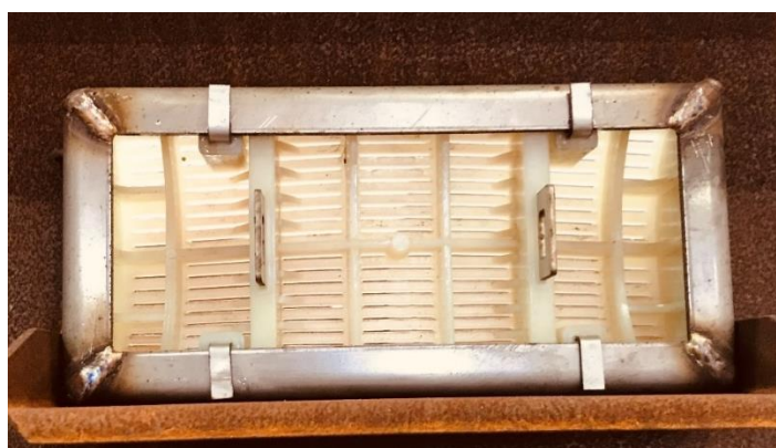
Figura 9 - Dreno côncavo com abertura de malha 1,2mm. Fonte: Arquivo pessoal.
