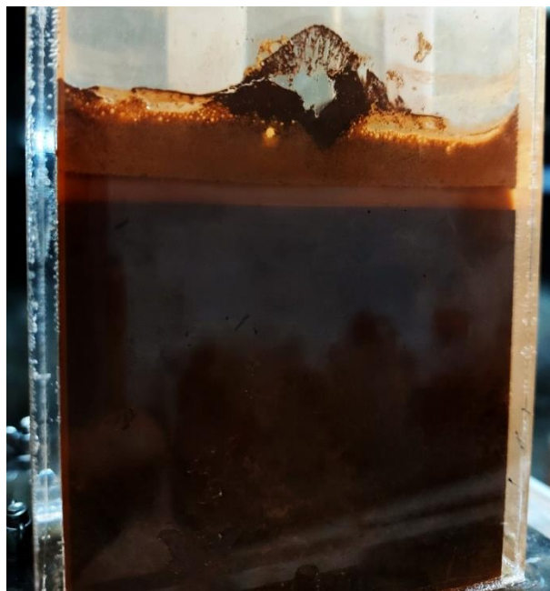
Figura 49 - Água livre expelida pela compactação do minério.
