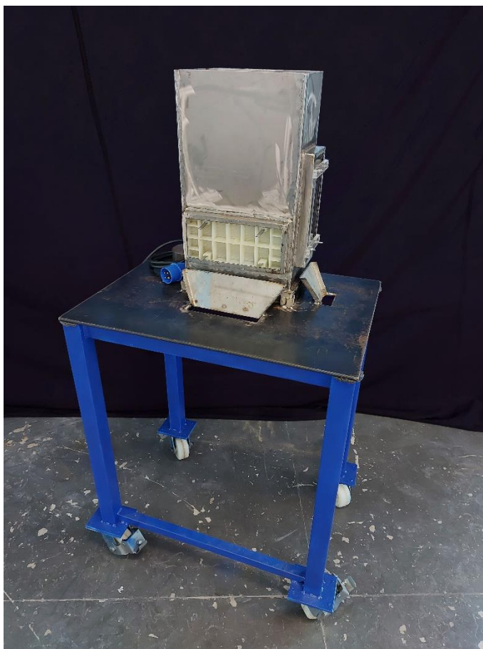
Figura 24 - Módulo de drenagem para bancada piloto.
