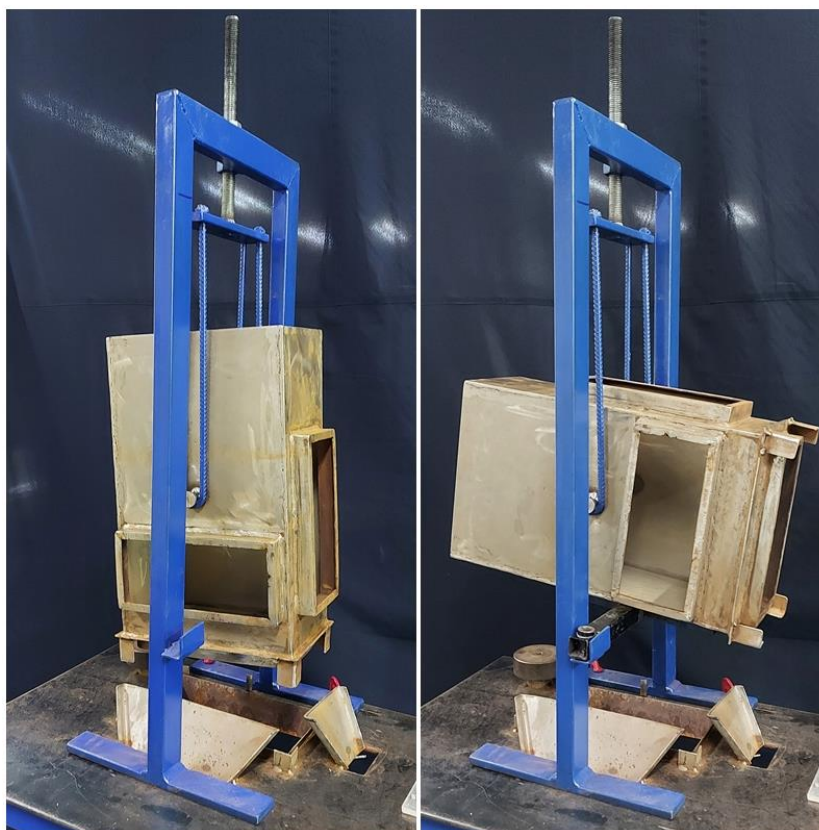
Figura 30 - Dispositivo de levantamento do tanque de ensaio.
