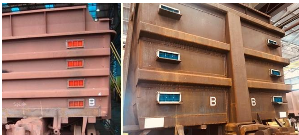
Figura 4 - Diferentes modelos de vagão tipo gôndola e aplicação de drenos de poliuretano. Fonte: Arquivo pessoal.
