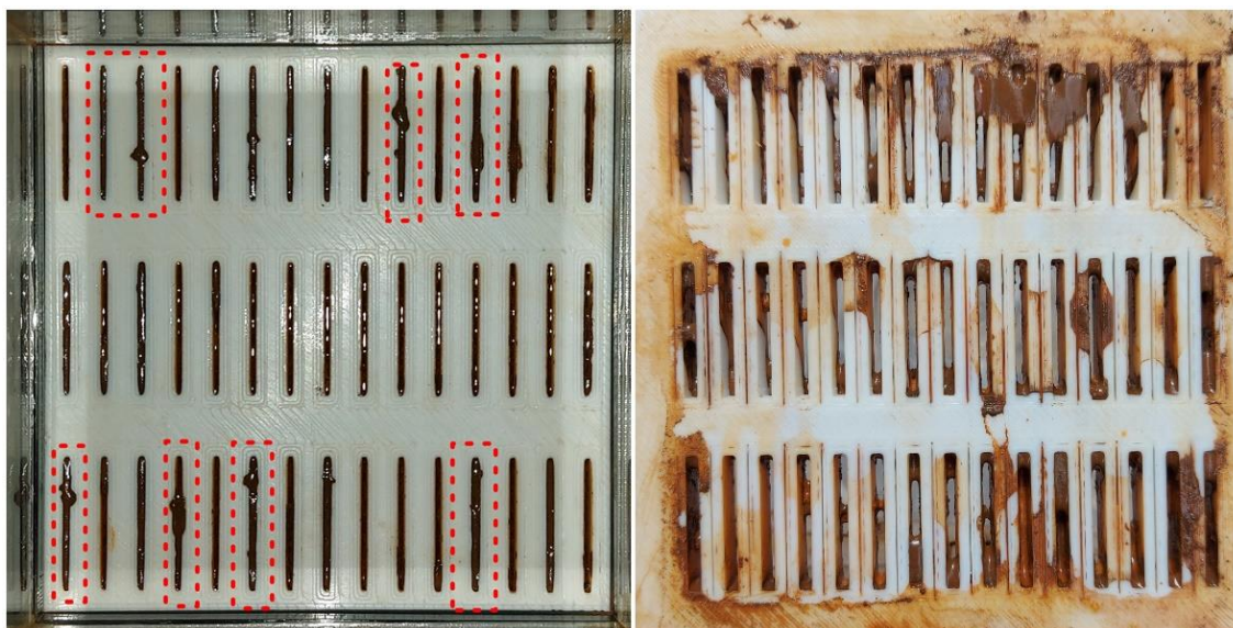
Figura 44 - Condição de drenos reto e trapezoidal após ensaio com 40% de saturação inicial
