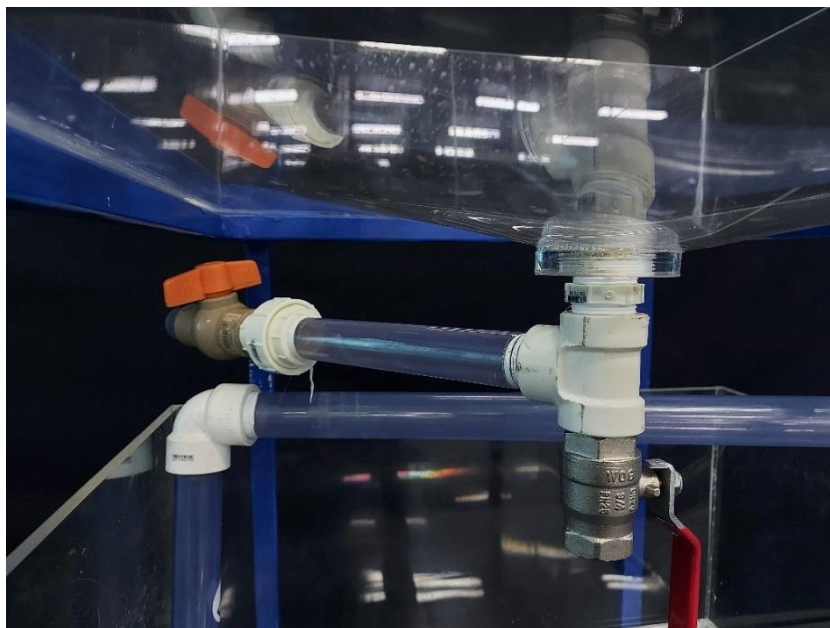
Figura 29 - Tanque de coleta com subdivisão de coleta.
