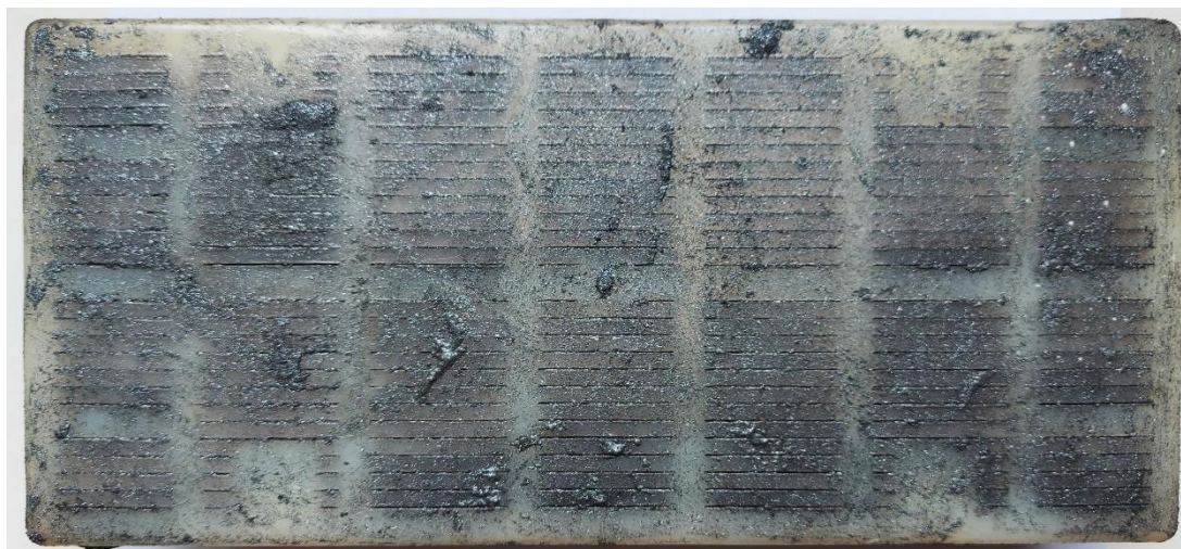
Figura 69 - Aspecto do dreno de fundo após ensaio.
