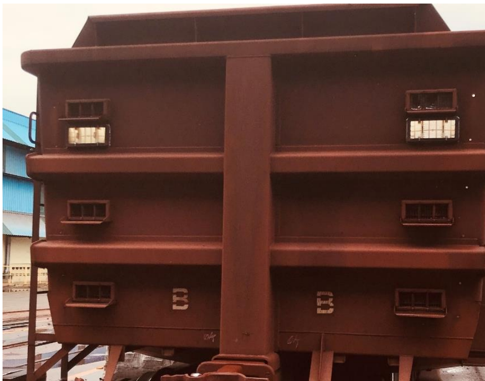
Figura 7 - Vagão tipo gôndola com alterações na disposição de dreno. Fonte: Vale, 2020.
