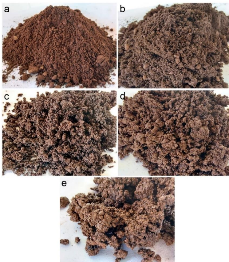
Figura 39 - Concentrações mássica de água no Sinter Feed: a)2,78%; b)5,41%; c)7,89%; d)10,26%; e)12,50%
