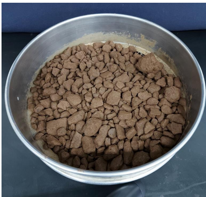
Figura 36 - Amostra de particulado retido em Mesh 5 para Sínter Feed.
