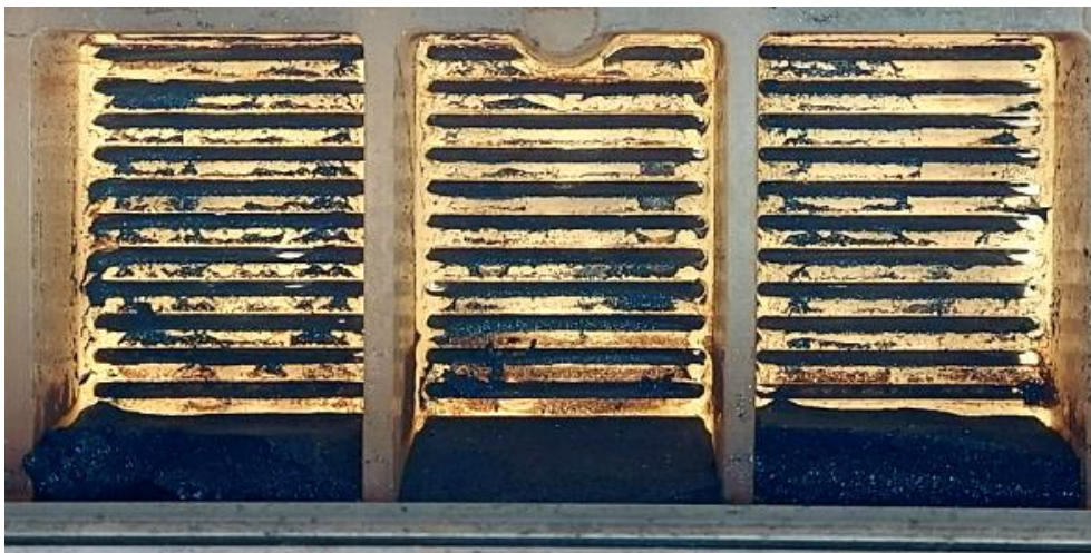
Figura 71 - Face externa de dreno após ensaio com Pellet Feed.
