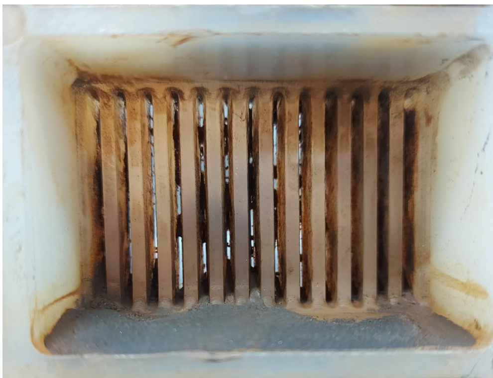
Figura 66 - Frestas de dreno lateral vertical após ensaio.
