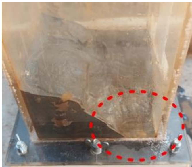
Figura 55 – Formação de canal de escoamento em dreno com 1,5mm de fresta.
