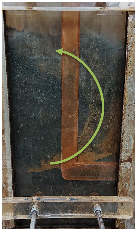
Figura 68 - Região de turbilhão em ensaio com Pellet Feed.
