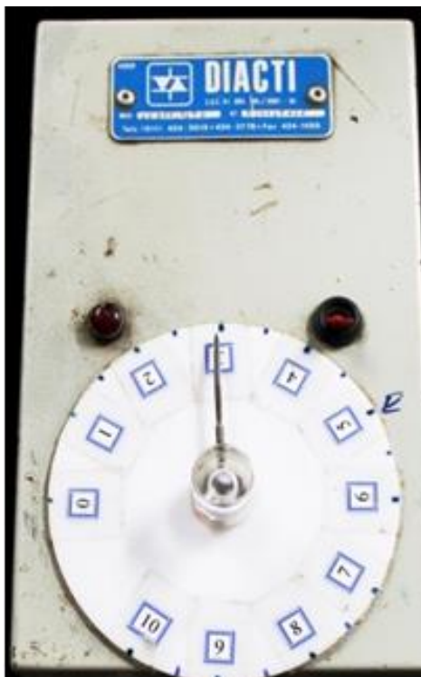
Figura 3.4 – Potenciômetro controlador da válvula rotativa.
