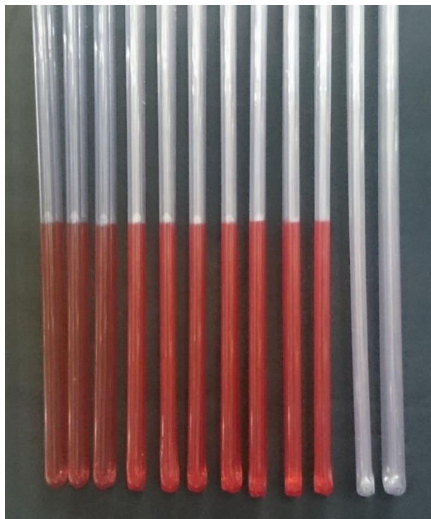
Figura 3.11 – Banco de Manômetros do tipo tubo em U.
