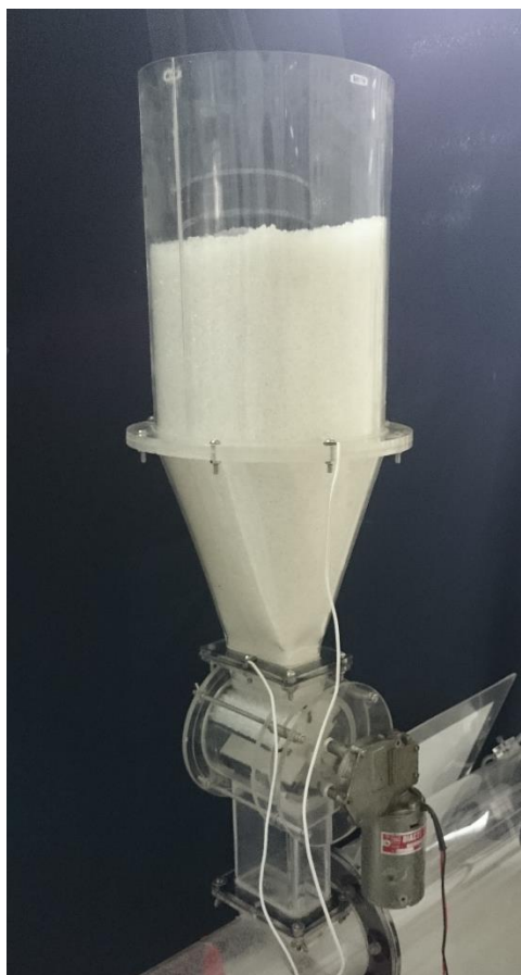
Figura 3.3 – Alimentação de sólido composta de silo com polipropileno granulado com diâmetro médio de 4,5mm e válvula rotativa acionada por um motor elétrico.
