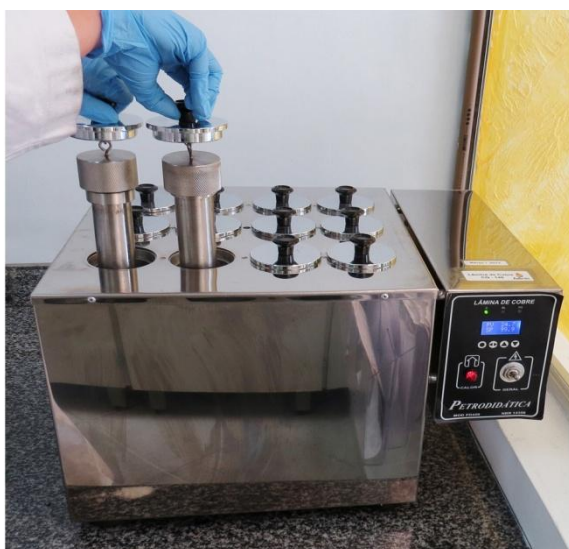
Figura 6. Corrosão em lâmina de cobre.
