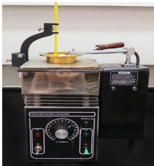
Figura 4: Aparelho de ensaio de Ponto de Fulgor.
