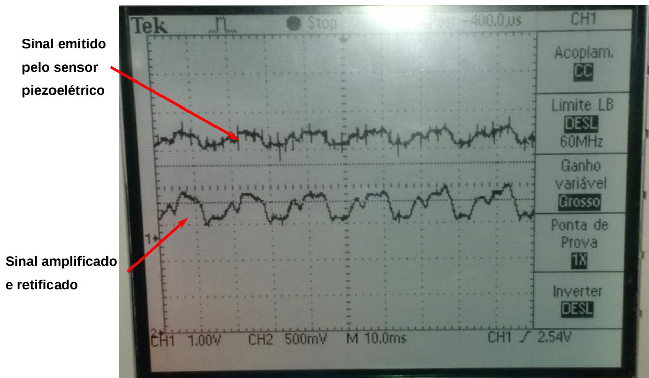
Figura 3-19 - Comparação entre onda de saída do circuito amplificador de sinal e do circuito retificador de onda.
