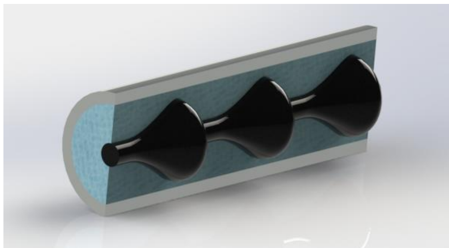
Figura 1-1 – Exemplo de padrão de escoamento Core Annular Flow .
