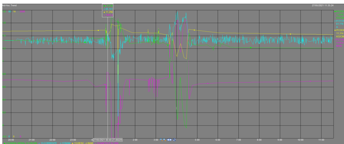
Figura 37. Ampliação do trend do processo, com admissão de bolsas de gás.
