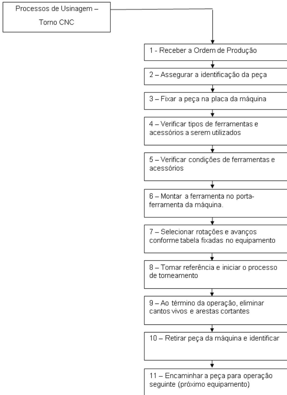
**Figura 13 - Processos de Usinagem em Torno CNC**
