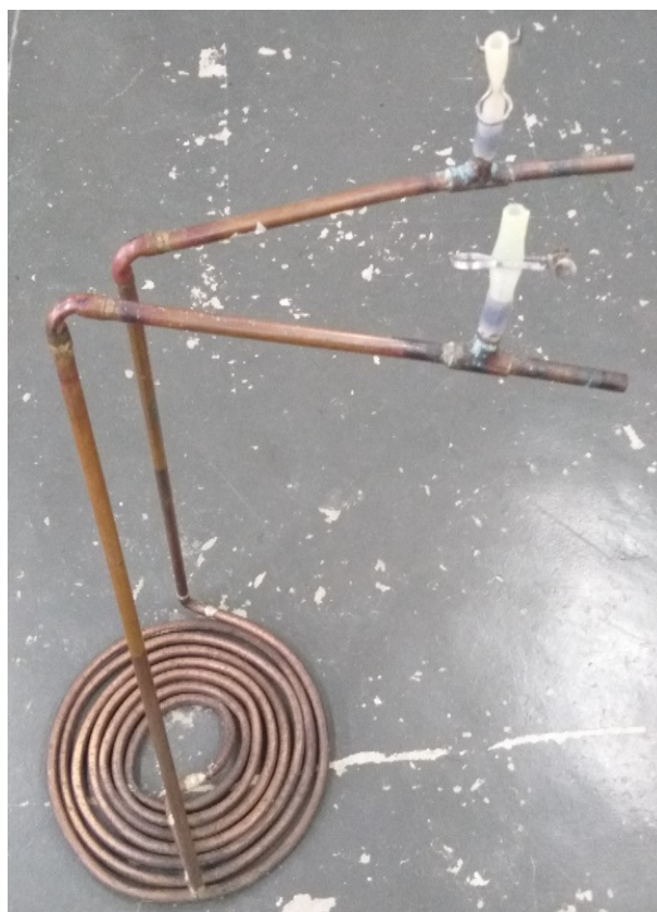
Figura 27 - Serpentina espiral projetada para tanque de 50L.
