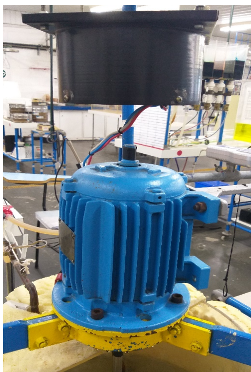
Figura 32 - Motor elétrico de 2HP em balanço.
