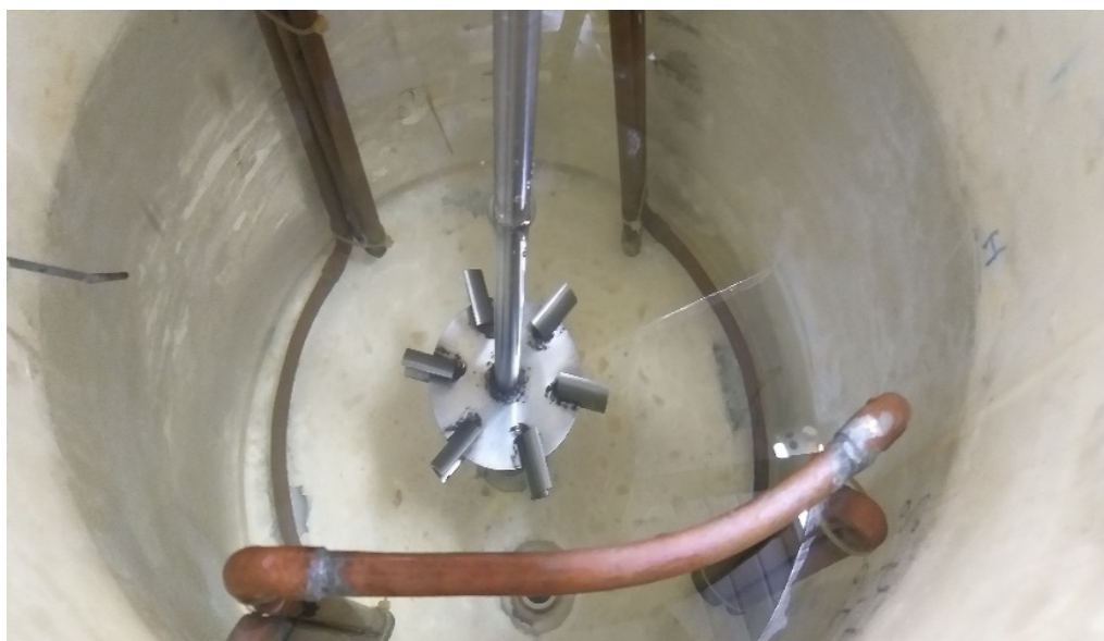
Figura 31 - Tanque equipado com impulsor Smith e chicanas tubulares verticais.
