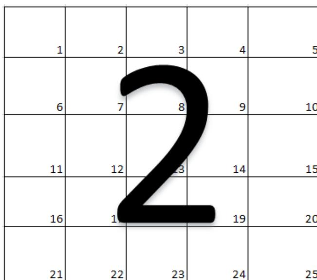
**Figura 19:** Código numérico 2 dividido em 25 subáreas para análise do *software* Arranjo Paraconsistente.
